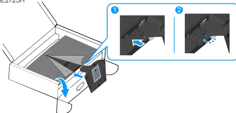
**Figura 14.** Fissare il supporto montato al monitor
