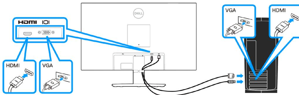
**Figura 18.** Collegamento del cavo VGA e del cavo HDMI (SE2725H)
