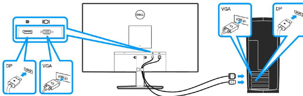
**Figura 17.** Collegamento del cavo VGA e del cavo DP (E2725H)
