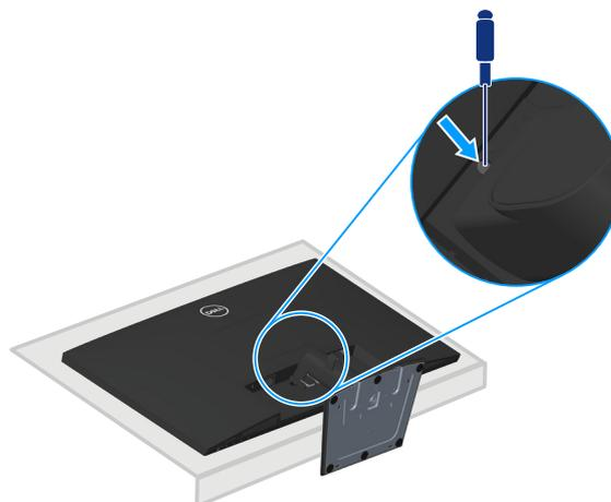
**Figura 24.** Utilizzare un cacciavite lungo per premere il tasto di rilascio
