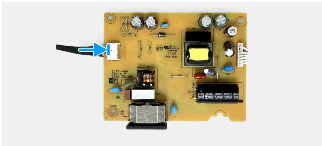
**Figura 33.** Instalar a placa de alimentação
