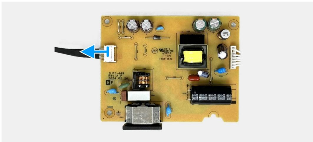
**Figura 32.** Remover a placa de alimentação
