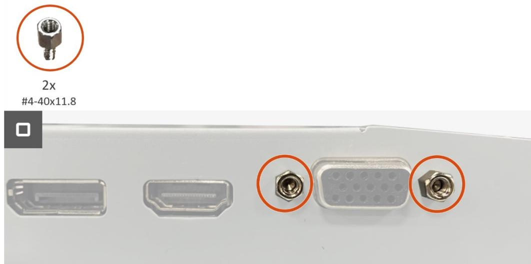
**Figura 31.** Instalar a placa de interface
