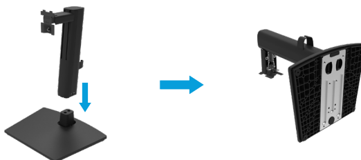
Afbeelding 13. De standaard in elkaar zetten
