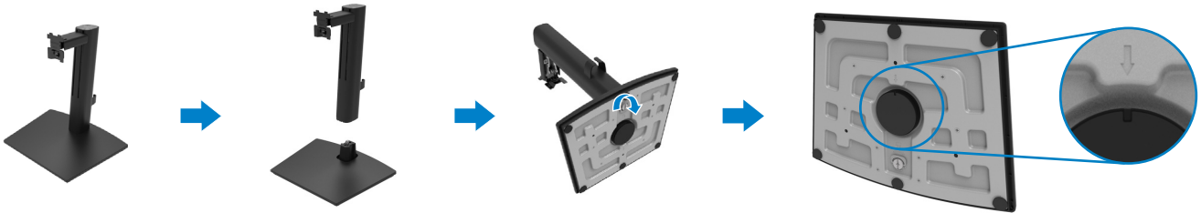
Afbeelding 16. De standaard in elkaar zetten
