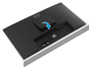
Afbeelding 14. De VESA-beschermkap verwijderen
