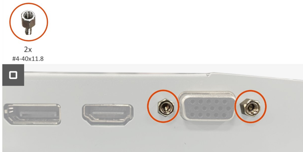
Figura 31. Installazione della scheda di interfaccia
