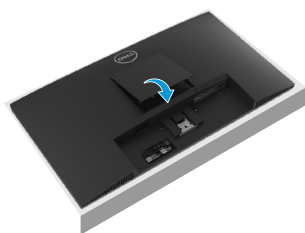
Figura 14. Montare la copertura VESA
