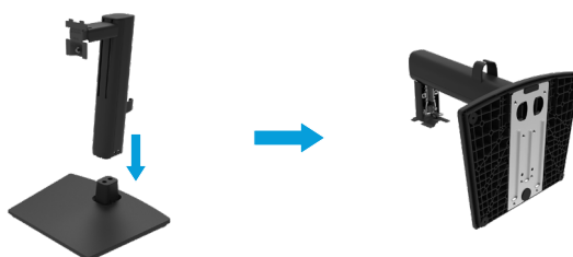
Figura 13. Montare il supporto
