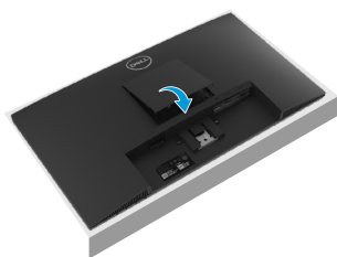
Figura 17. Montare la copertura VESA
