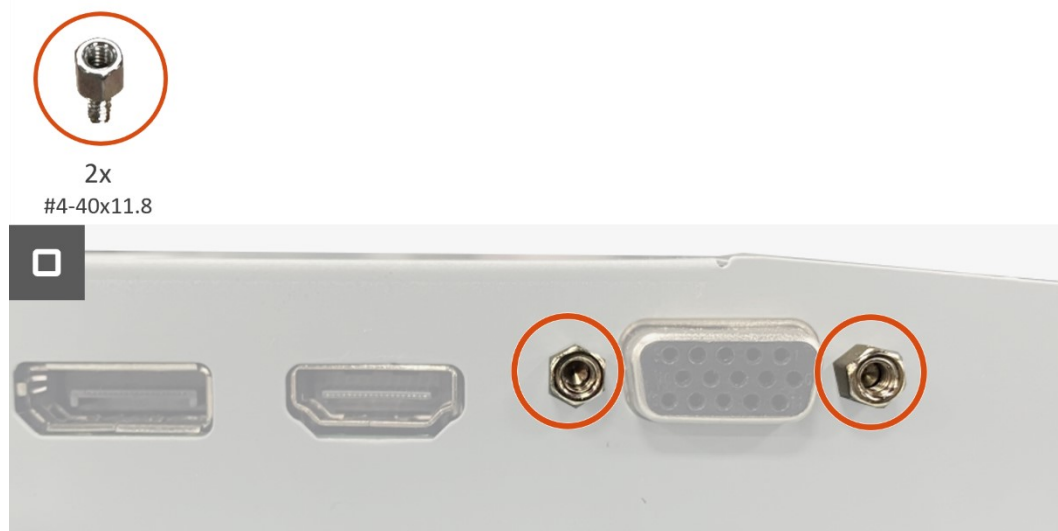
Schéma 31. Installez la carte d'interface
