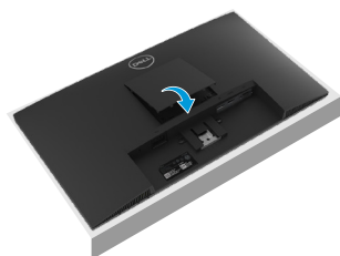
Rysunek 17. Montaż pokrywy VESA
