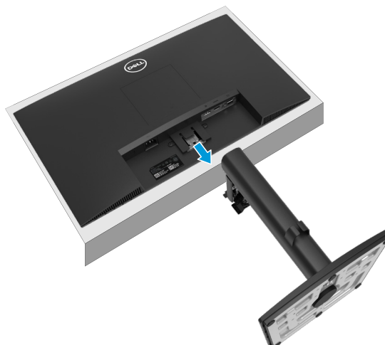
Rysunek 28. Wyciągnąć podstawę z monitora
