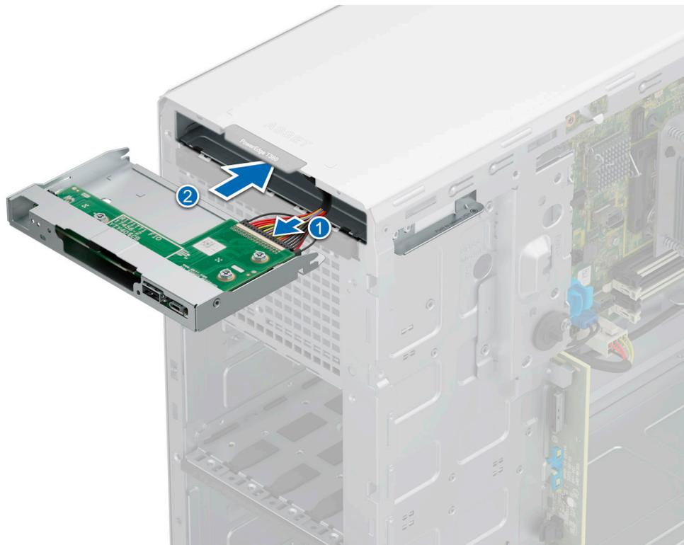
**Ilustración 96. Instalación de la canastilla del panel de control**
