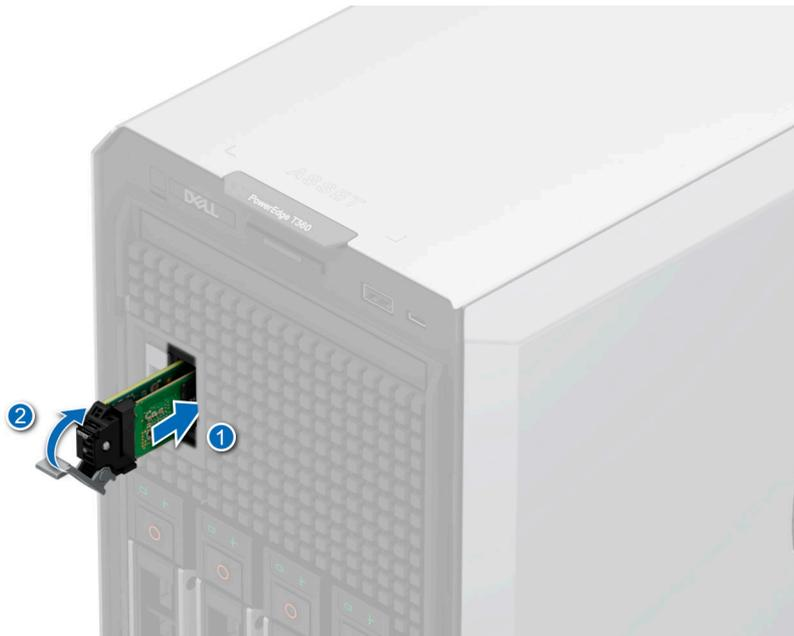
**Ilustración 75. Instalación del portatarjetas de BOSS-N1**
