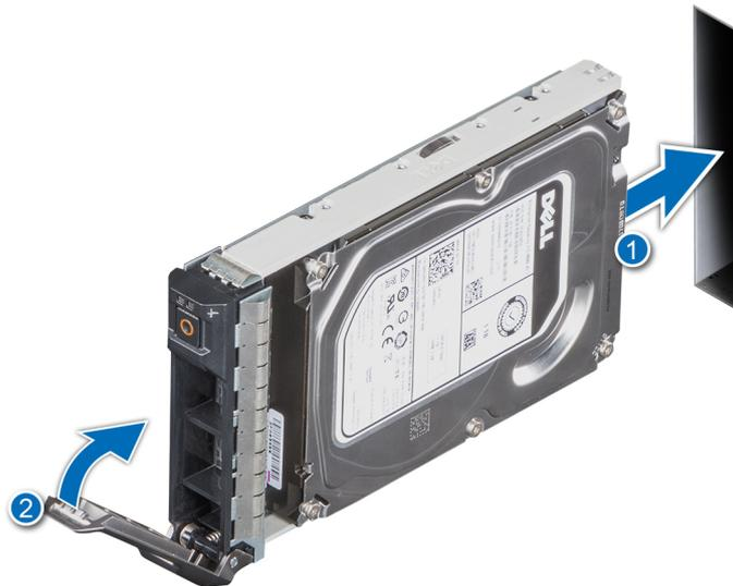
**Ilustración 27. Instalación de un portaunidades**
