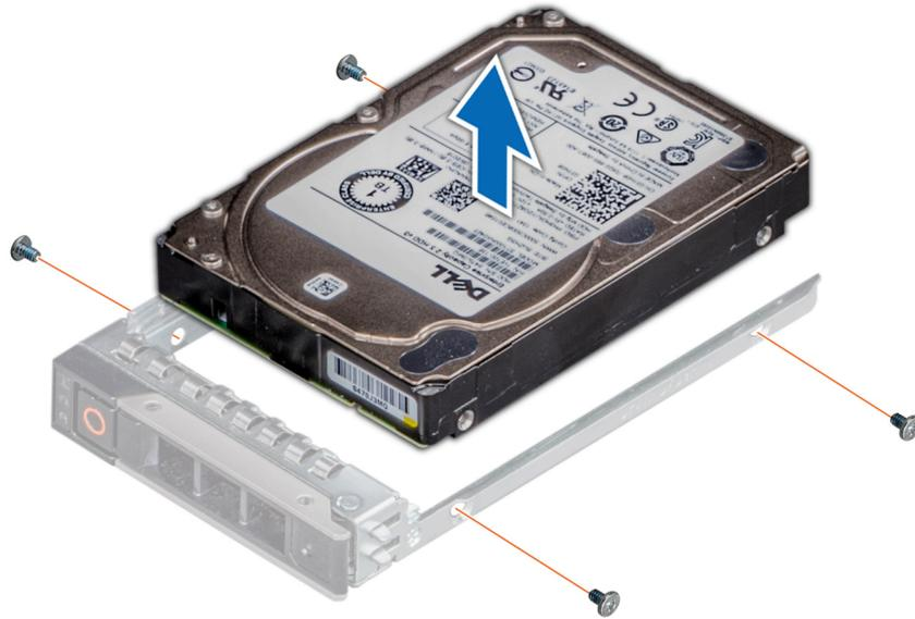
**Ilustración 28. Extracción de una unidad del portaunidades**
