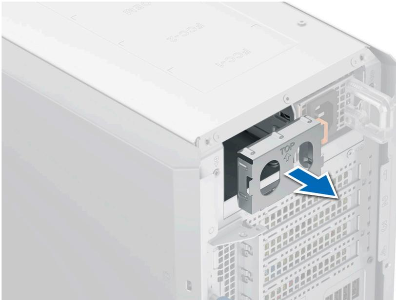
Ilustración 76. Extracción de una fuente de alimentación de relleno
