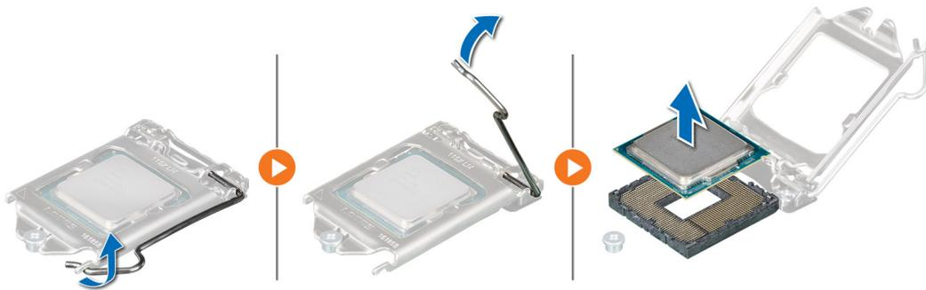
Ilustración 53. Extracción del procesador
