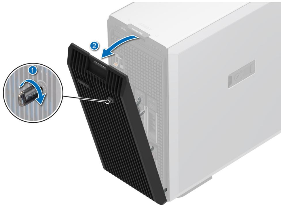
**Ilustración 12. Extracción del bisel frontal**
