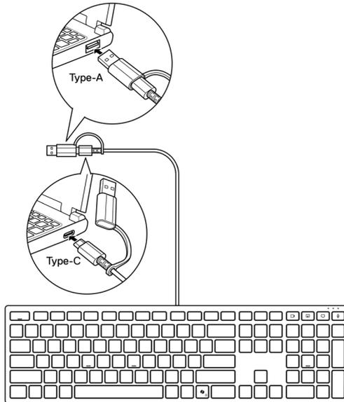
**REMARQUE :** Ce clavier est doté de deux types de connecteurs USB : type-A et type-C.
