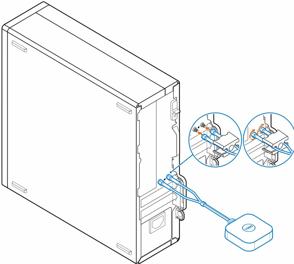
4. Faites glisser le cache SMA par-dessus les câbles d'antenne.
