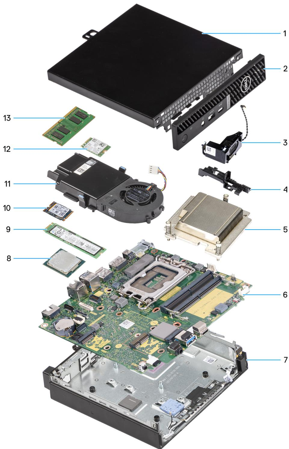
Figure 8. Principaux composants de l'ordinateur OptiPlex Micro 7020
