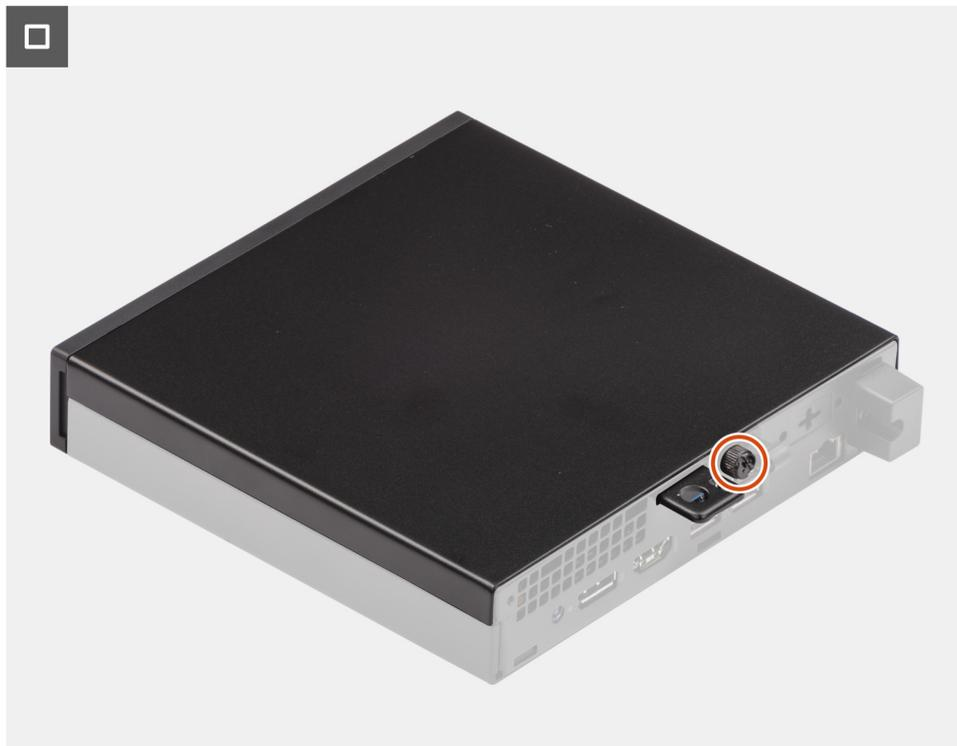
Figure 12. Installation du capot latéral
