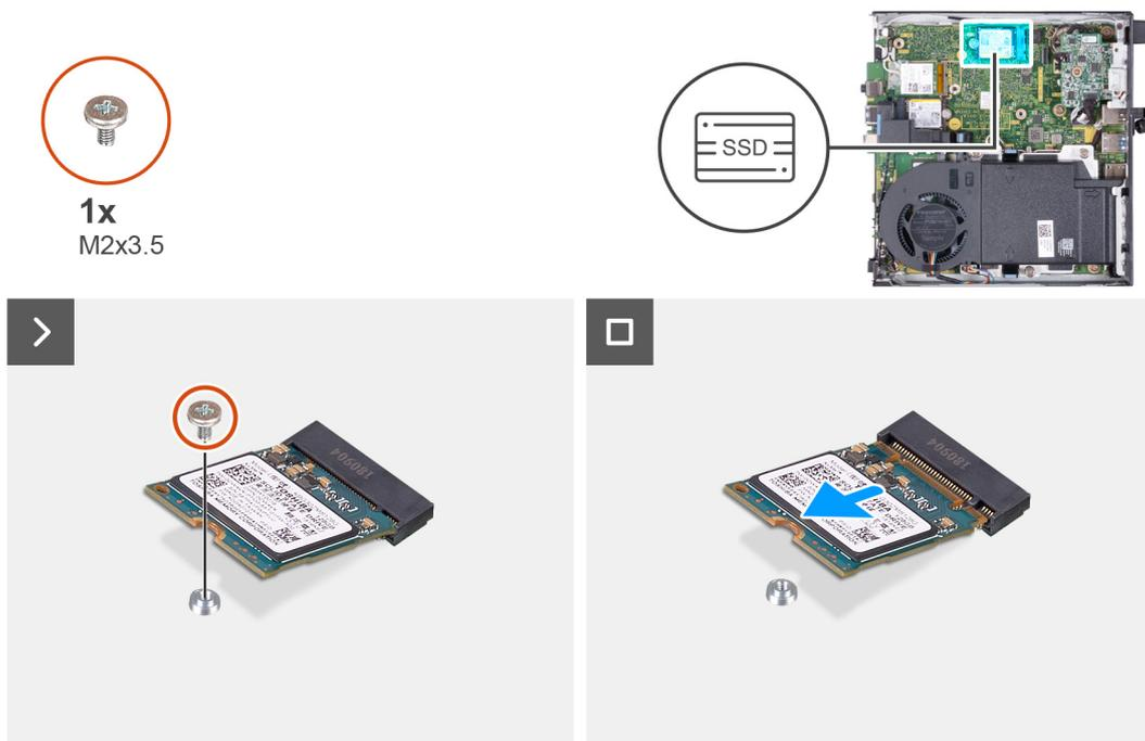
Figure 23. Retrait du disque SSD M.2 2230 du logement 1
