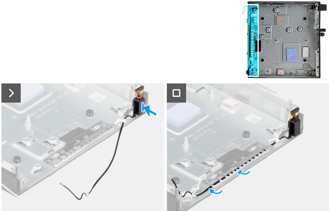
Figure 53. Installation du module d'antenne (câble noir)
