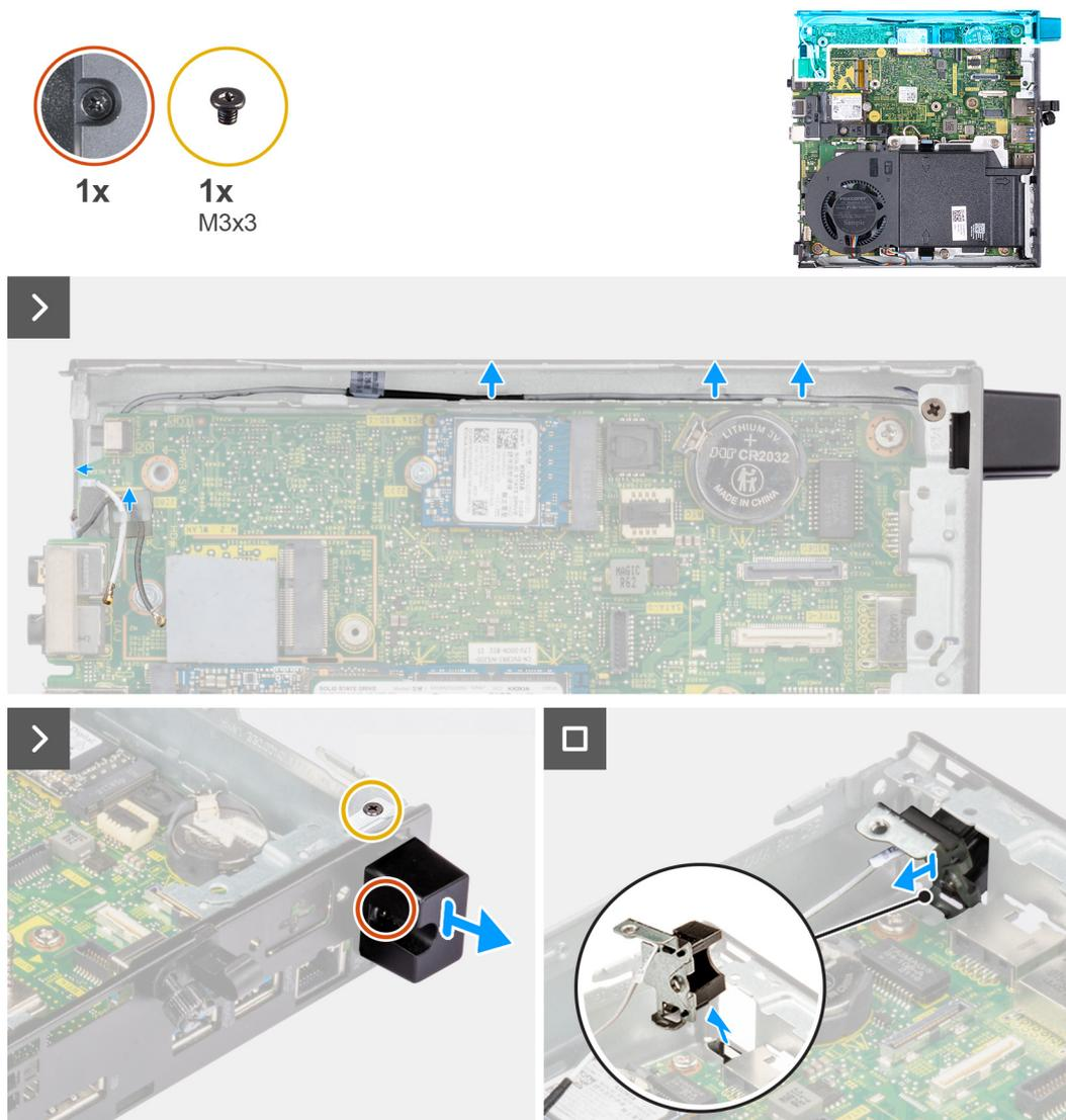
Figure 50. Retrait du module d'antenne (câble blanc)
