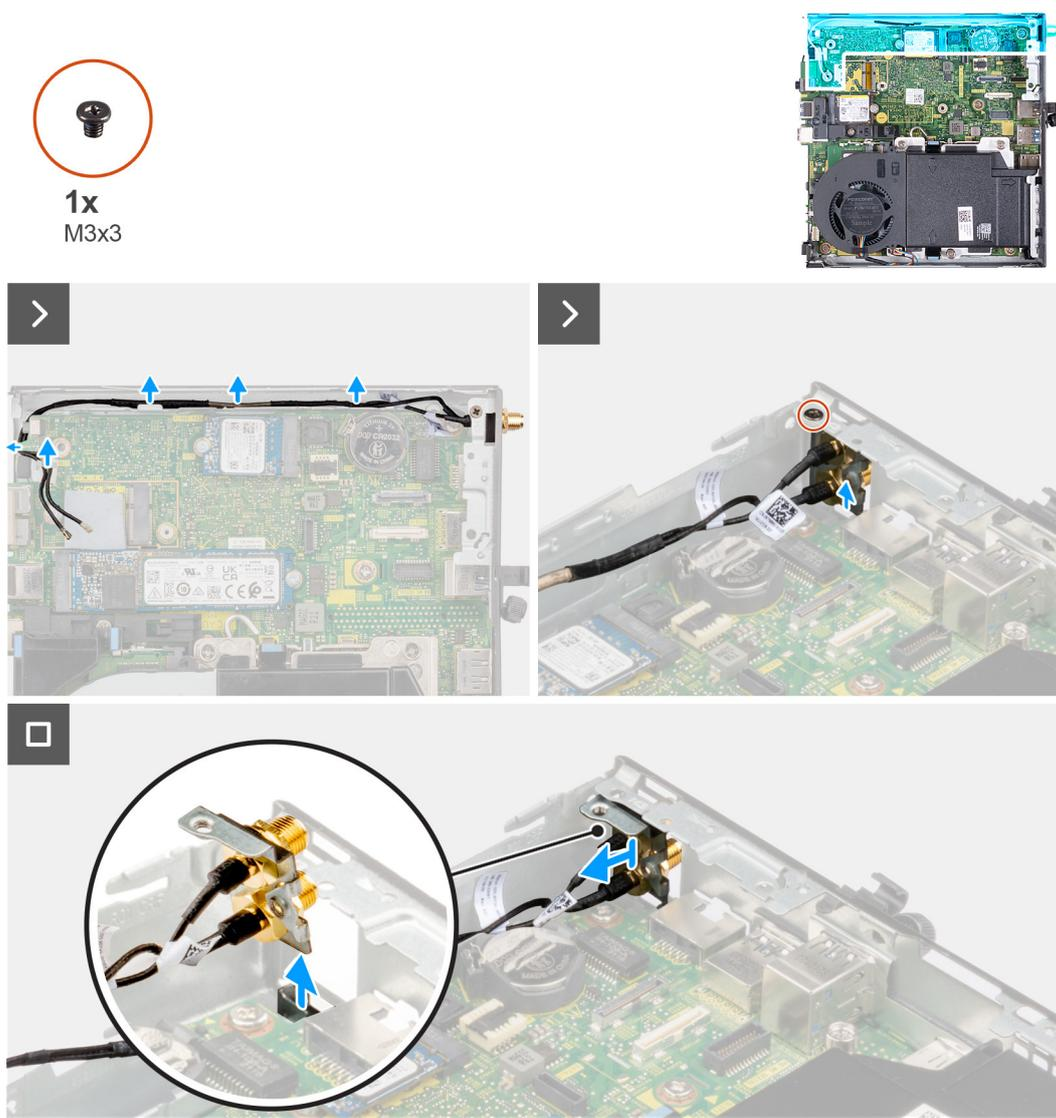
**Figure 54. Retrait de l'antenne SMA (emplacement 3)**
