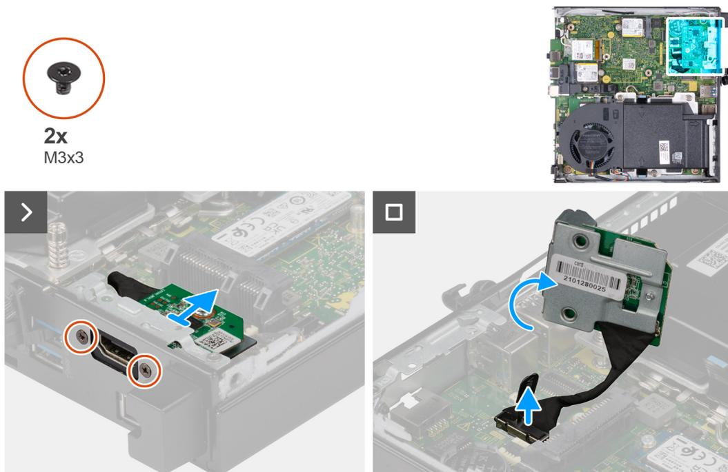
Figure 34. Retrait du module d'E/S en option (HDMI, DP ou PS2)
