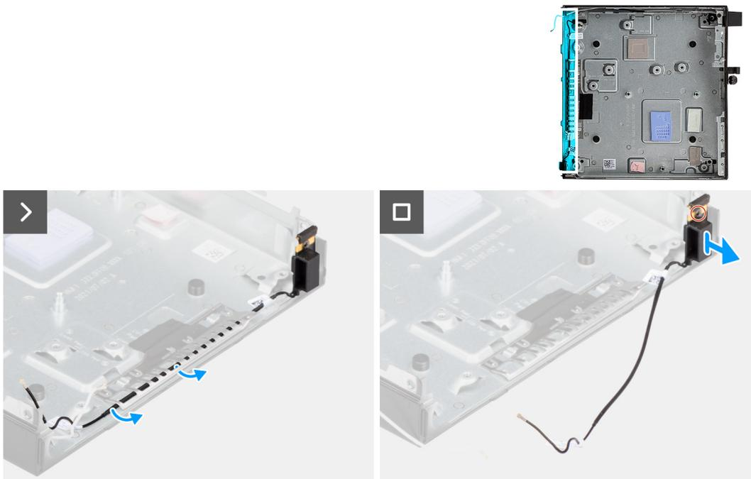
Figure 52. Retrait du module d'antenne (câble noir)
