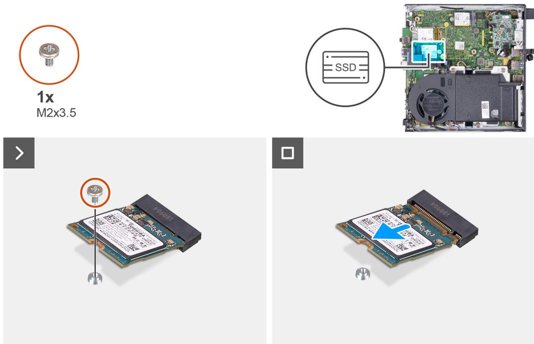
Figure 19. Retrait du disque SSD 2230 du logement 0
