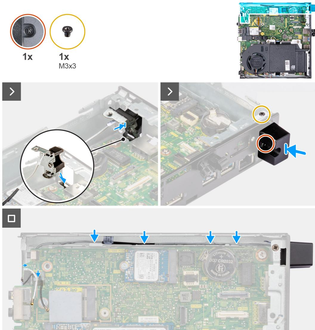
Figure 51. Installation du module d'antenne (câble blanc)
