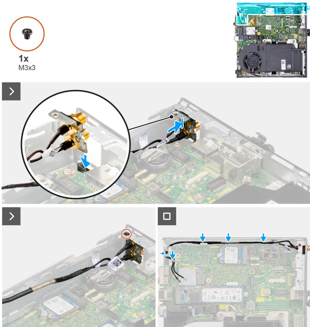
Figure 55. Installation de l'antenne SMA (emplacement 3)
