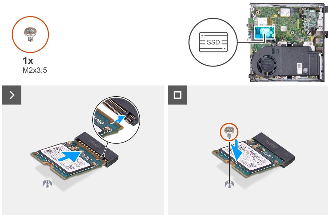
Figure 20. Installation du disque SSD 2230 dans le logement 0
