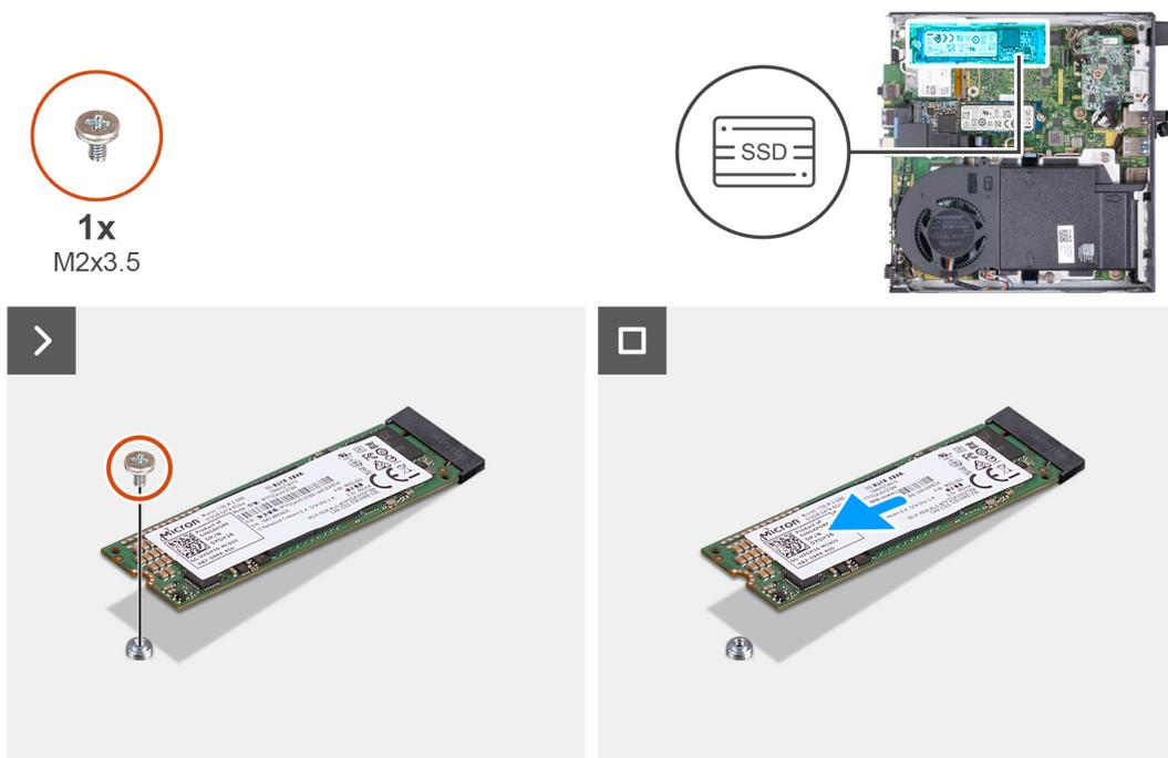
Figure 25. Retrait du disque SSD M.2 2280 du logement 1
