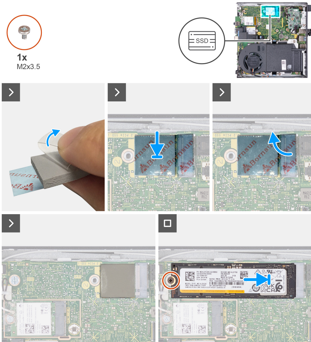
Abbildung 26. Installieren des M.2 2280-Solid-State-Laufwerks in Steckplatz 1
