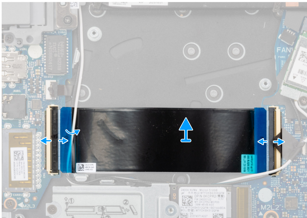
Obrázek 34. Demontáž kabelu desky I/O
