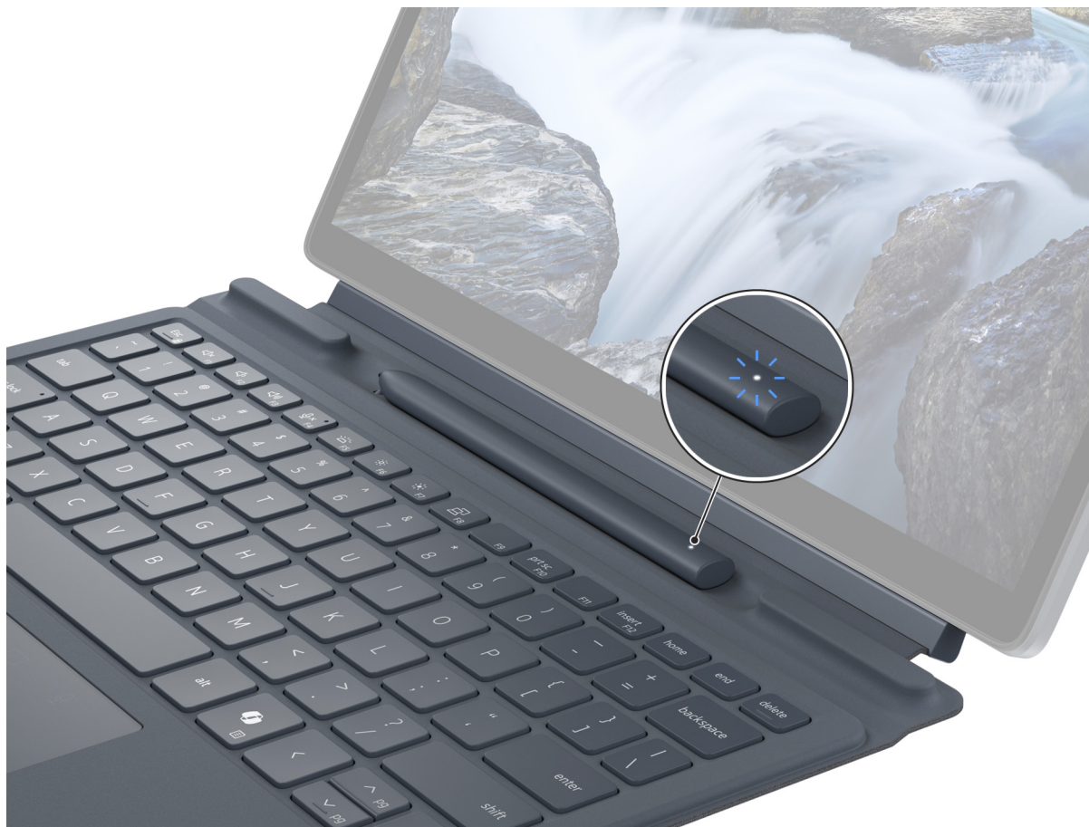
Figure 12. Chargement du stylet actif Latitude 7350 détachable
