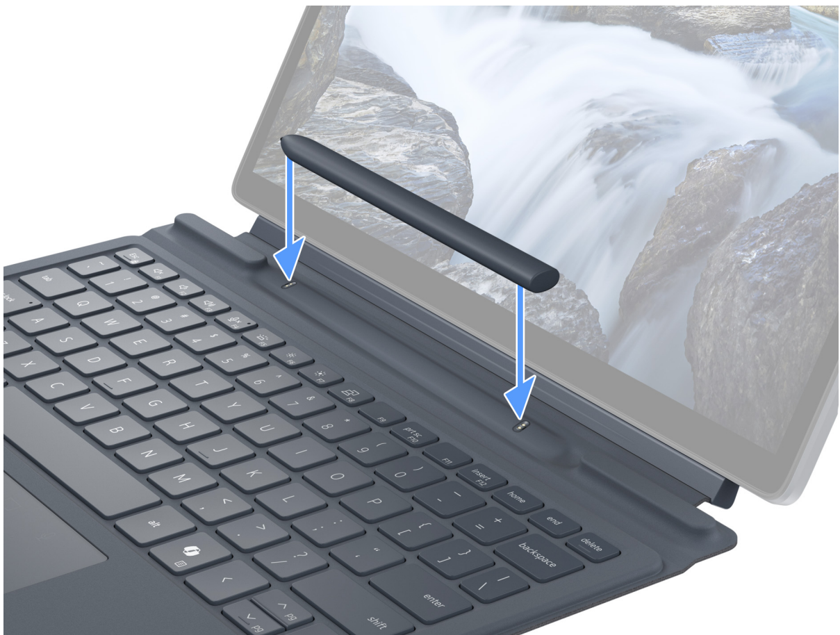
Figure 11. Connexion du stylet actif Latitude 7350 détachable
