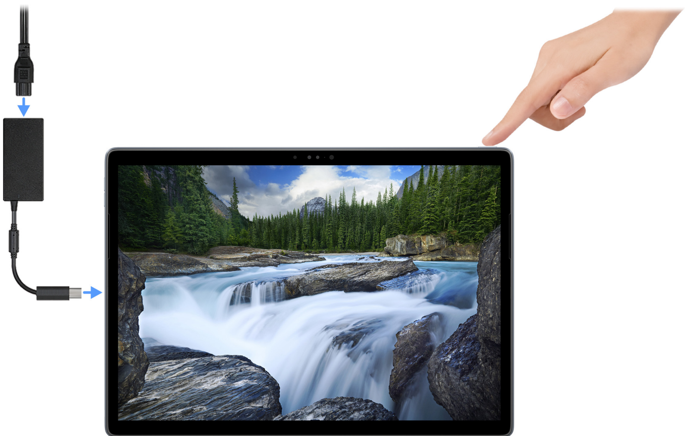
Figure 8. Branchez l'adaptateur secteur et appuyez sur le bouton d'alimentation
