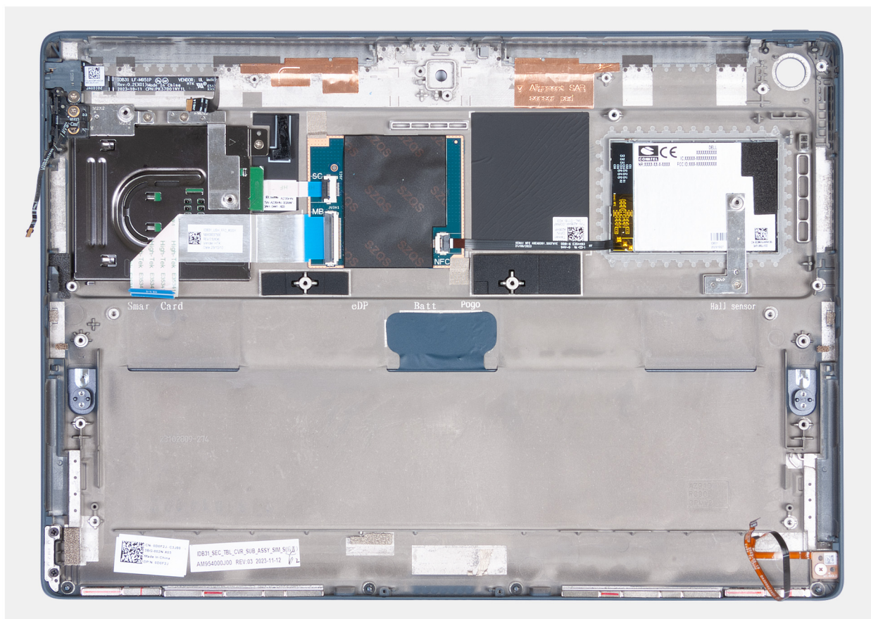
Figure 79. Installation du capot arrière de l'écran
