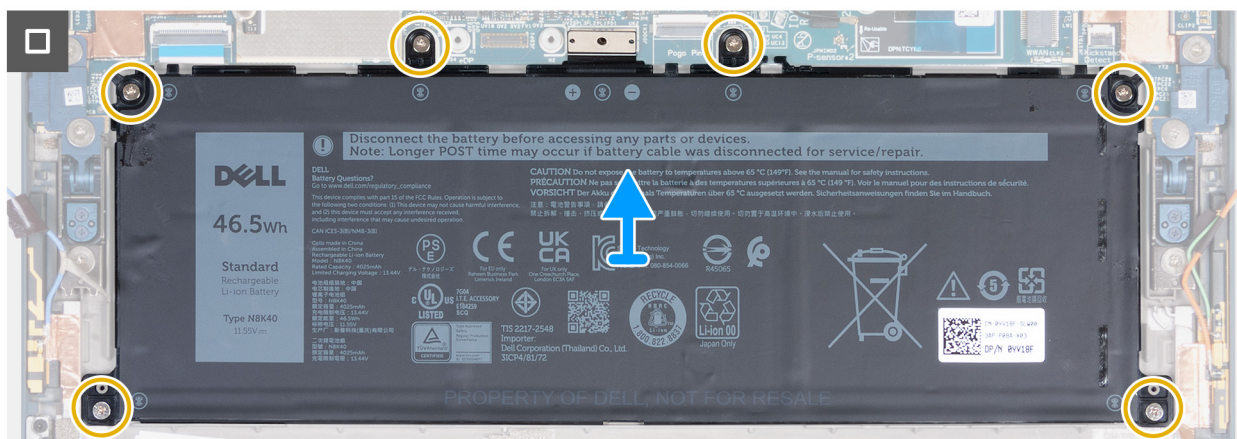
Figure 40. Retrait de la batterie
