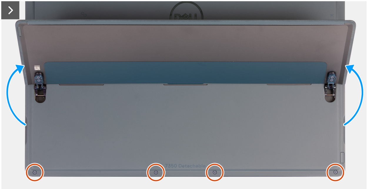
Figure 17. Retrait de l'assemblage d'écran
