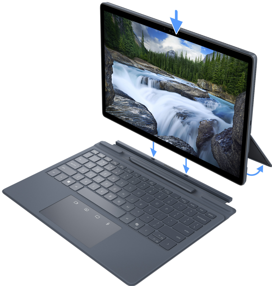
Figure 9. Fixation du clavier de collaboration Latitude 7350 détachable
