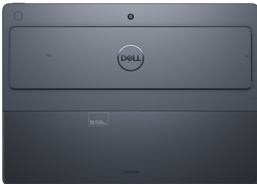
Figure 7. Emplacement de l'étiquette de service
