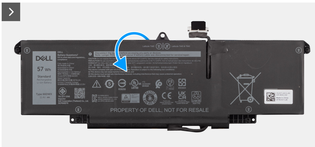
Afbeelding 45. De batterijkabel installeren
