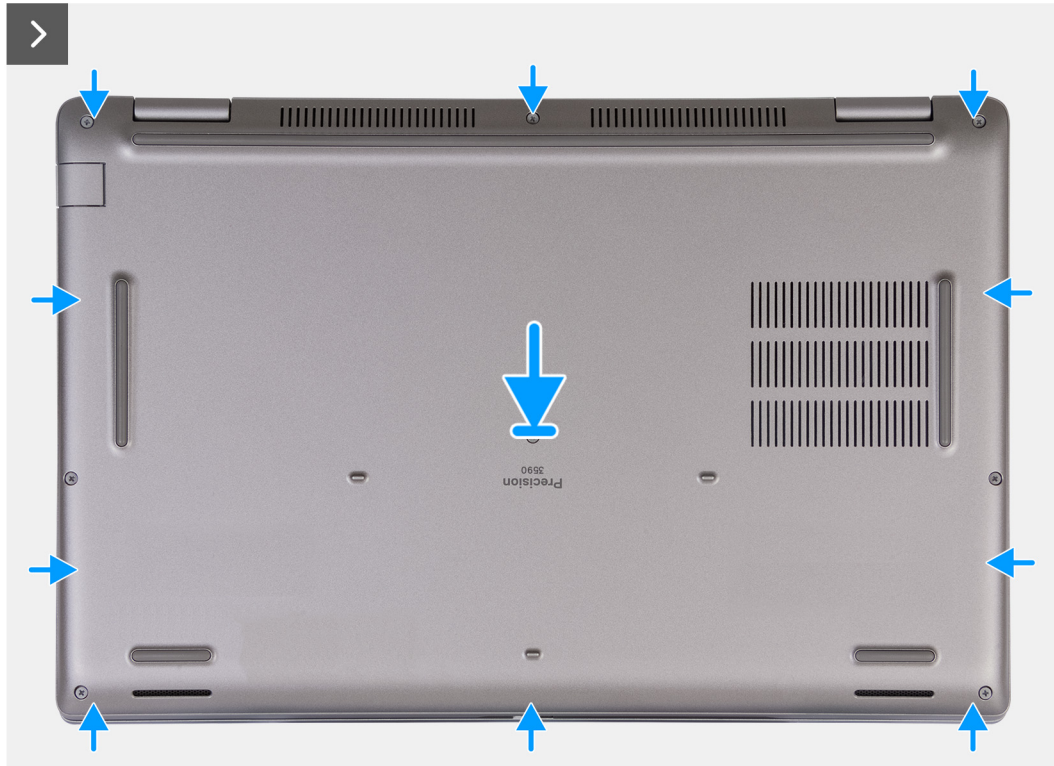
Figure 17. Installation du cache de fond
