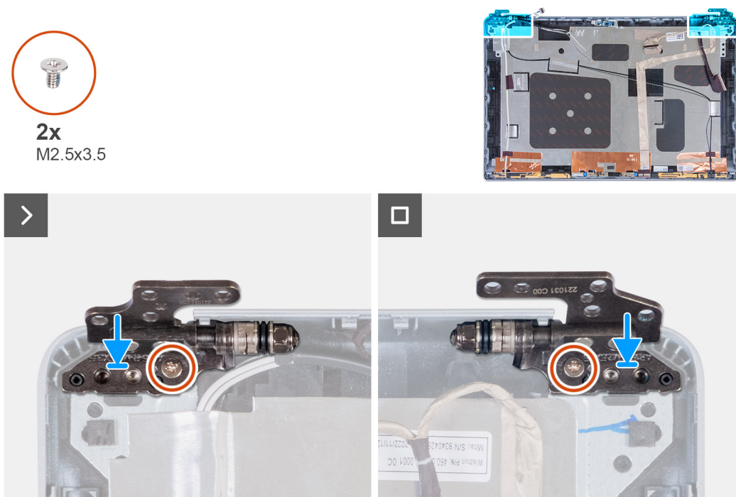
Figure 87. Installation des charnières d'écran
