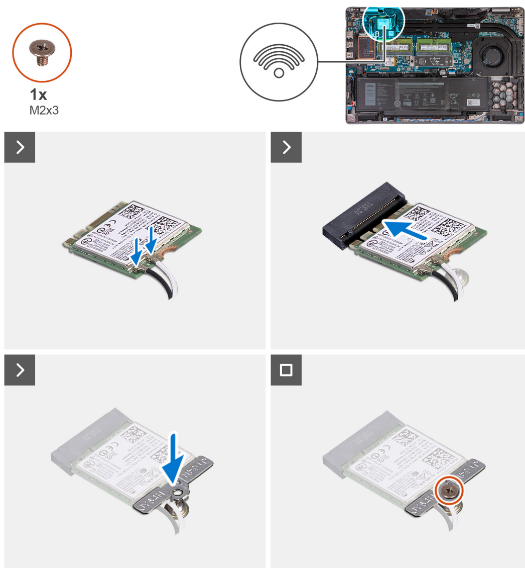
Figure 20. Installation de la carte sans fil
