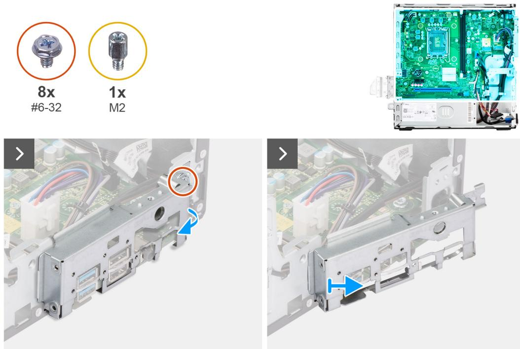
**Figura57. Retirar a placa de sistema**
