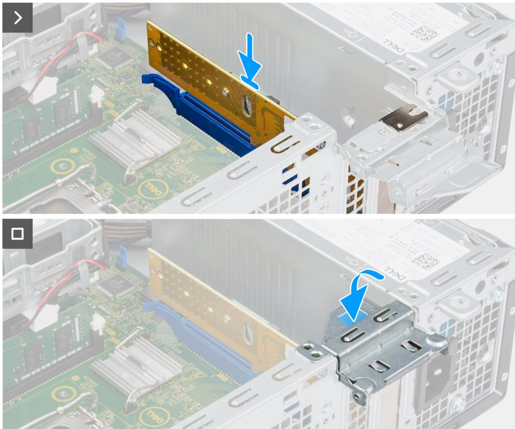
**Figura26. Instalar a placa do Disco Dell Ultra Speed de 3.ª Geração**
