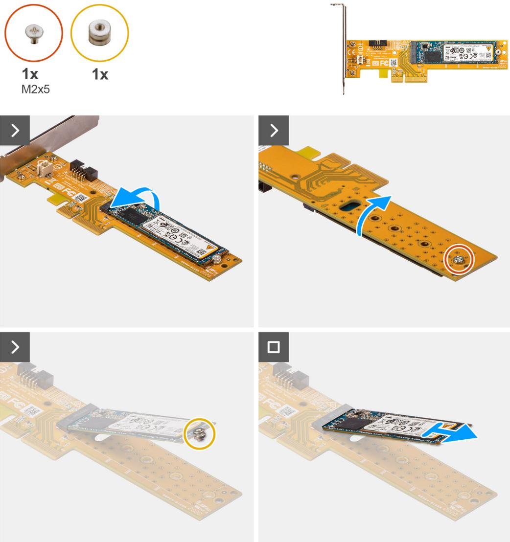
**Figura23. Retirar o disco de estado sólido M.2 2280 da placa do Disco Dell Ultra Speed de 3.ª Geração**
