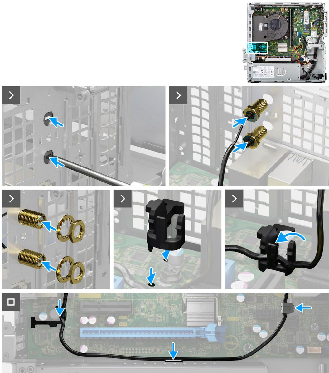
**Figura41. Instalar o módulo da antena SMA externa**
