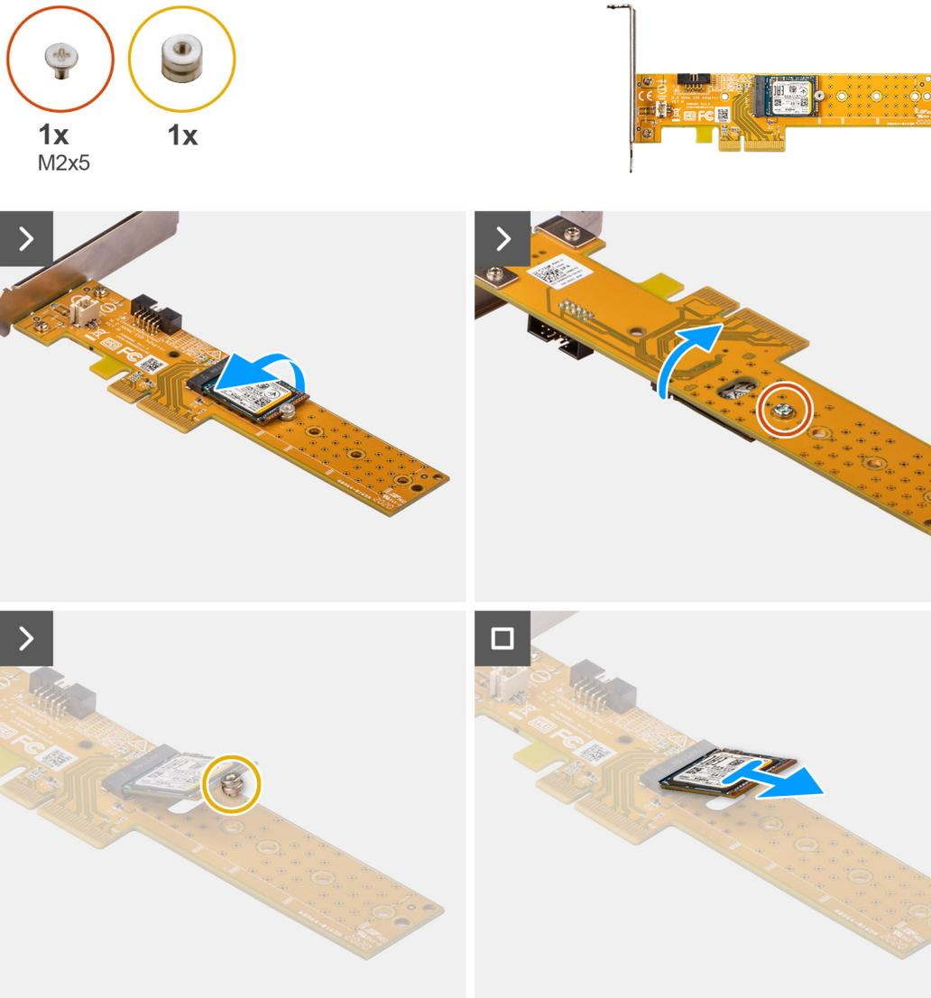
Figura22. Retirar o disco de estado sólido M.2 2230 da placa do Disco Dell Ultra Speed de 3.ª Geração
