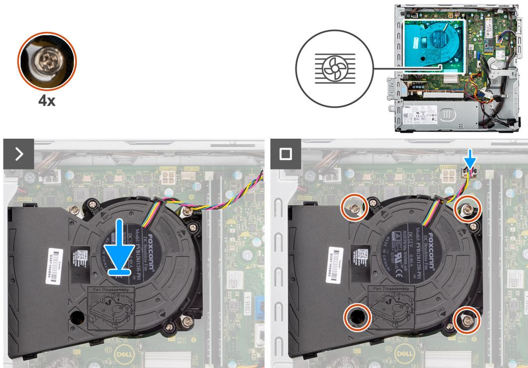
**Figura45.** Instalar o conjunto da ventoinha e dissipador de calor do processador
