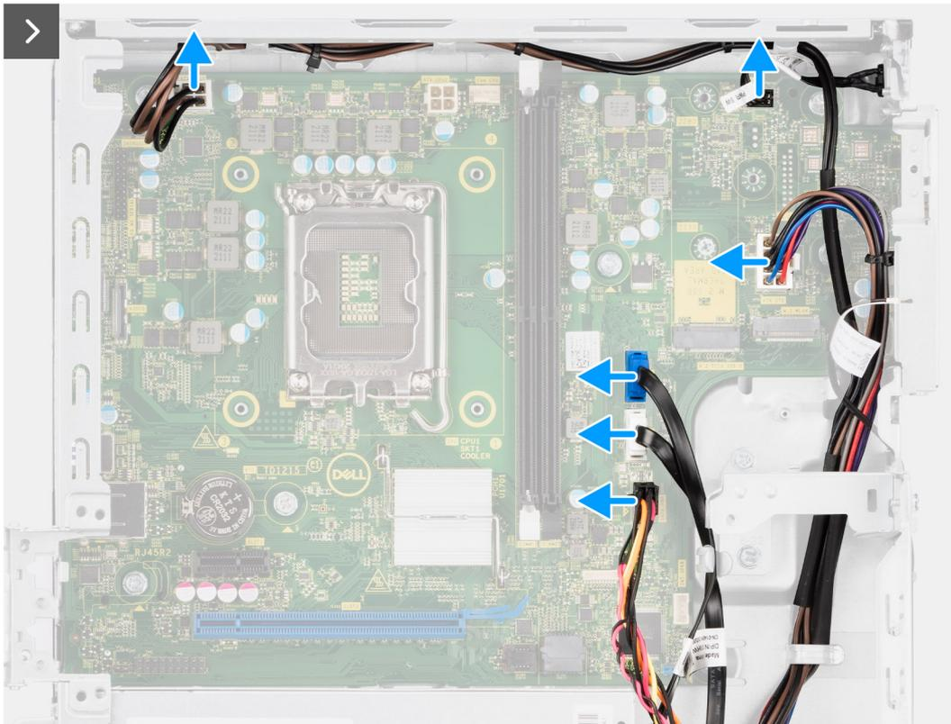
**Figura58. Retirar a placa de sistema**
