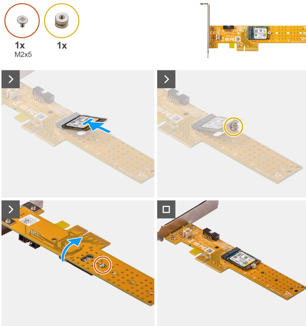
Figura24. Instalar o disco de estado sólido M.2 2230 na placa do Disco Dell Ultra Speed de 3.ª Geração
