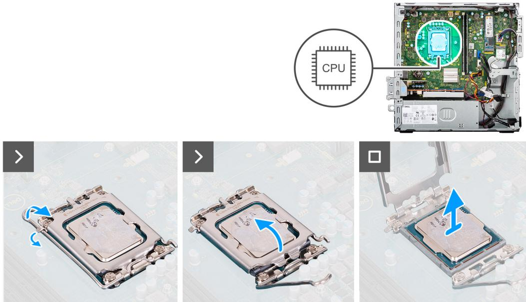
**Figura46. Retirar o processador**
