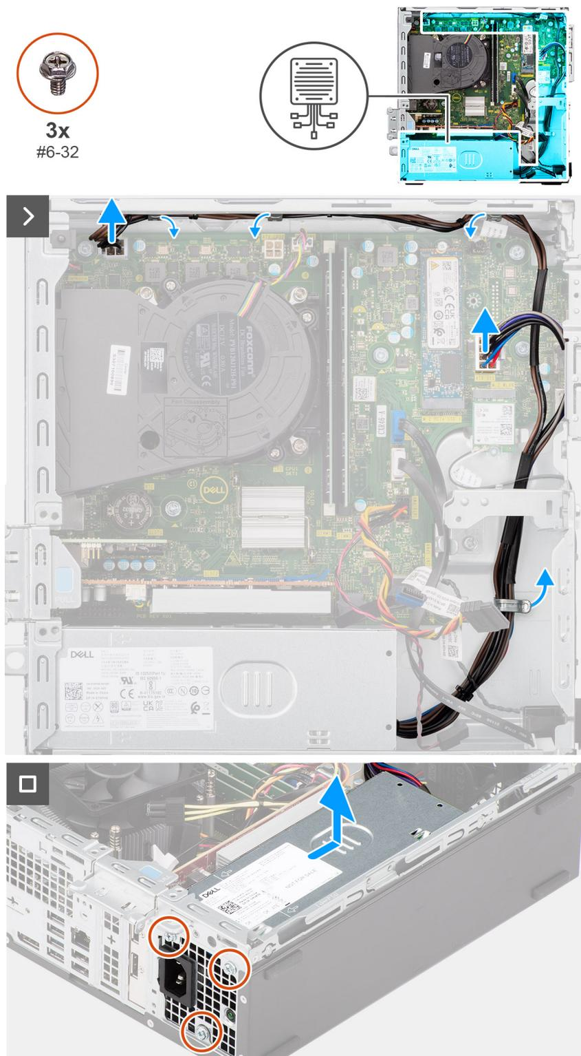
**Figura42. Retirar a unidade de fonte de alimentação**
