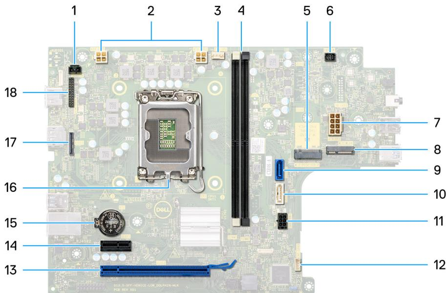
**Figura56. Descrição geral da placa de sistema**
