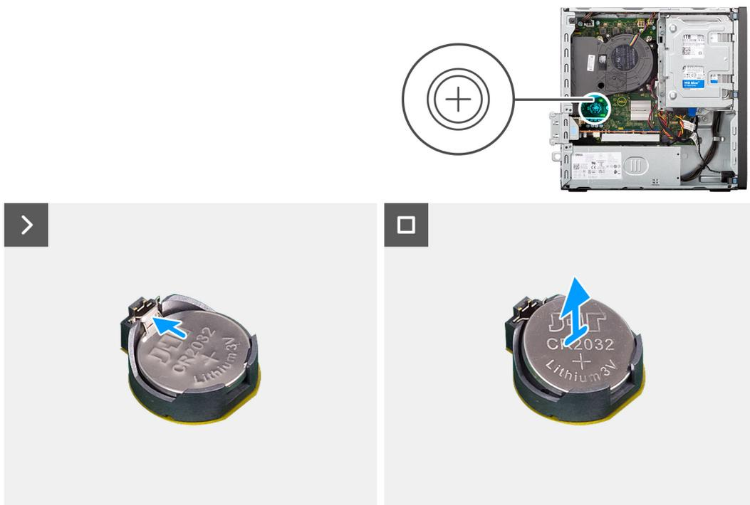
Figura5. Retirar a bateria de célula tipo moeda
