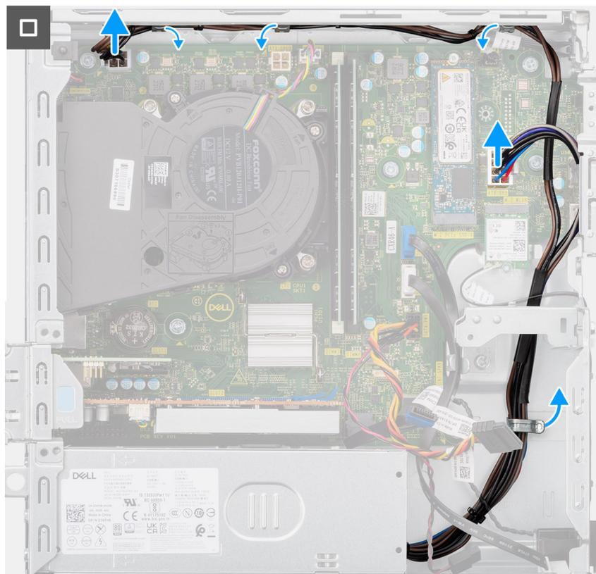
**Figura43. Instalar a unidade de fonte de alimentação**
