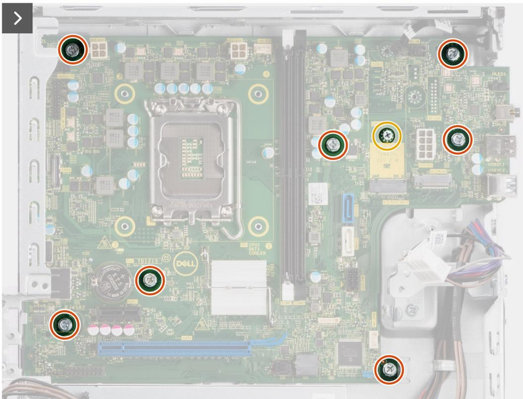
**Figura63. Instalar a placa de sistema**
