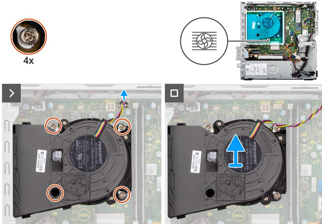
**Figura44. Retirar o conjunto da ventoinha e dissipador de calor do processador**
