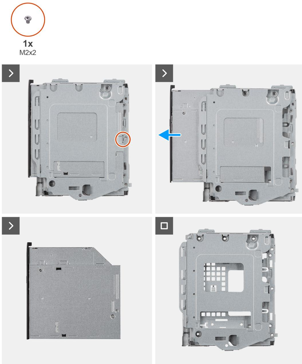
**Figura13. Retirar o disco ótico**
