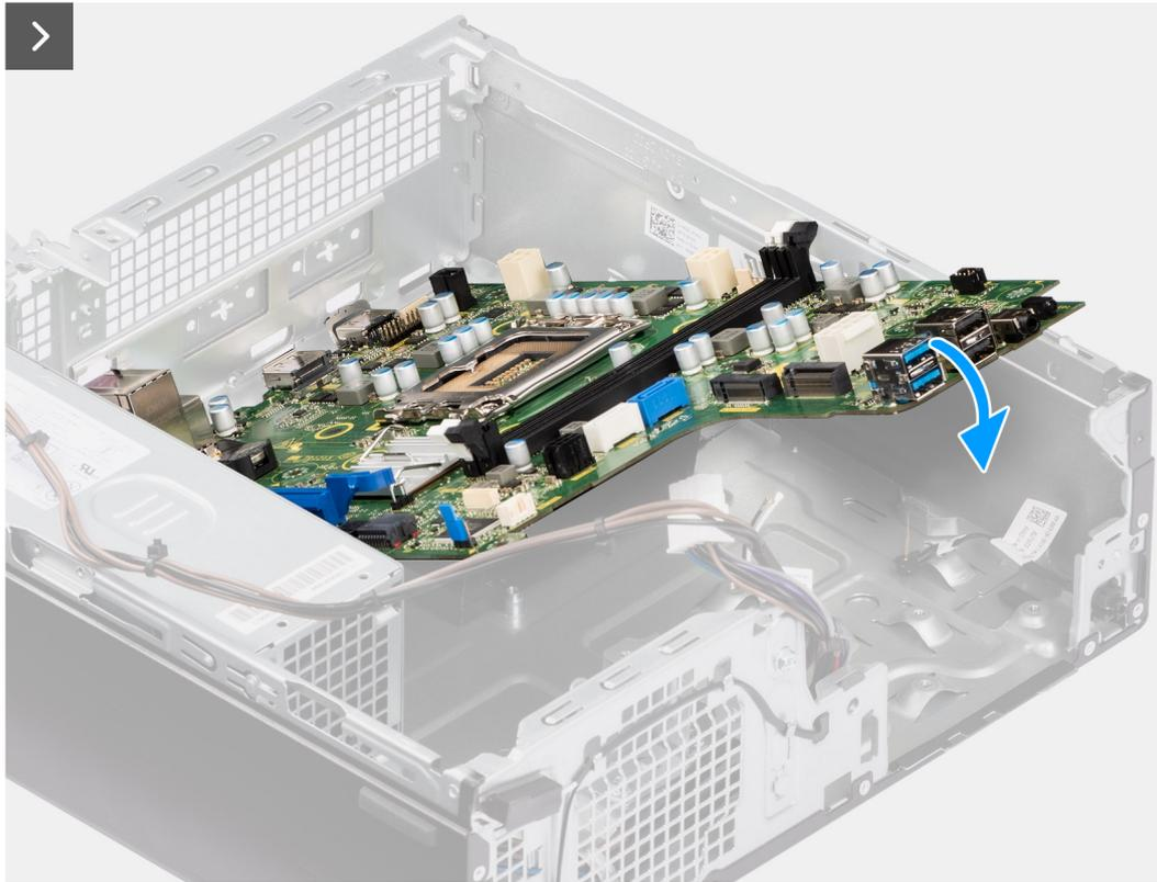
**Figura62. Instalar a placa de sistema**
