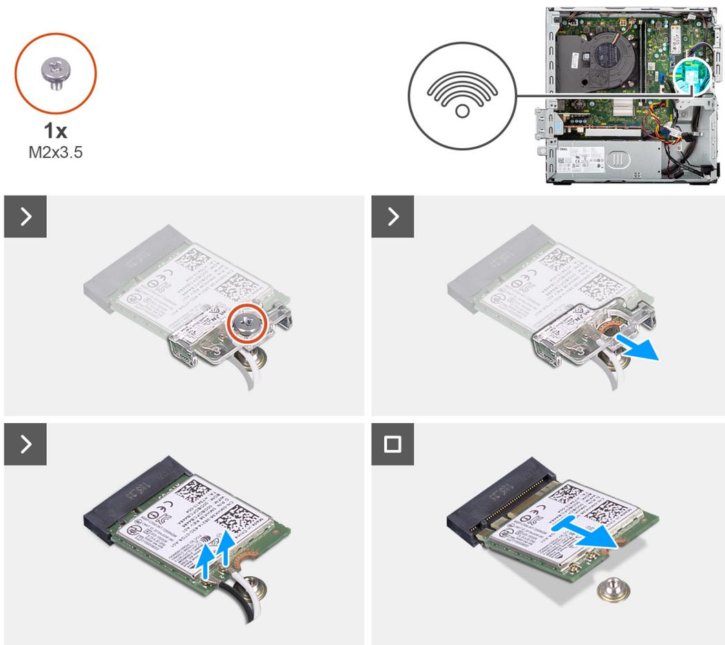
Figura27. Retirar a placa de comunicação sem fios
