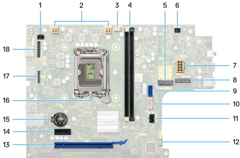
**Figura61. Descrição geral da placa de sistema**
