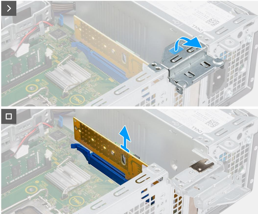
Figura21. Retirar a placa do Disco Dell Ultra Speed de 3.ª Geração
