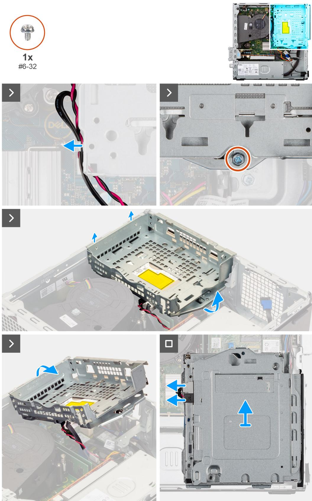
Figura11. Retirar a caixa do disco rígido
