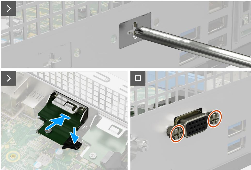
**Figura51. Instalar o módulo VGA**
