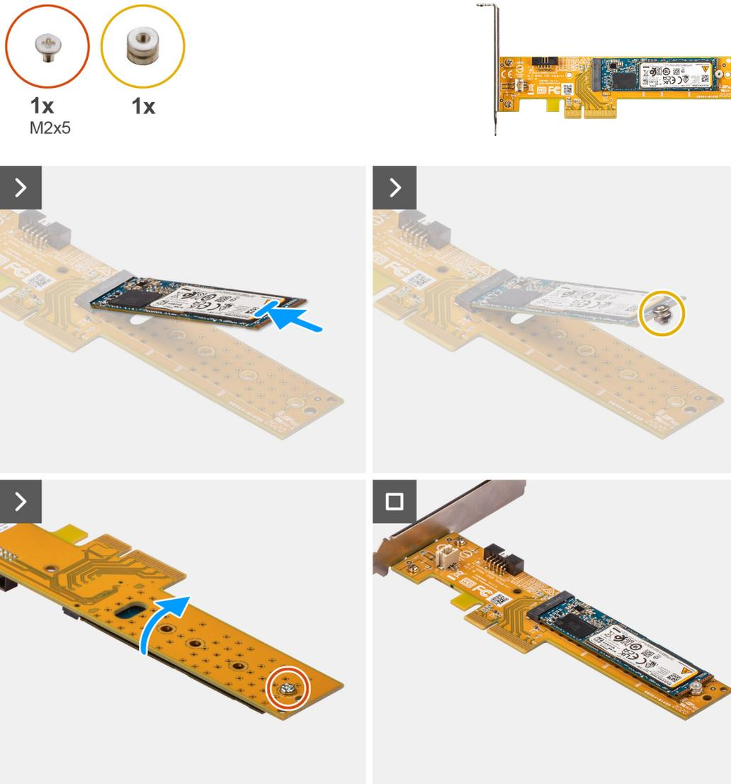
Figura25. Instalar o disco de estado sólido M.2 2280 na placa do Disco Dell Ultra Speed de 3.ª Geração
