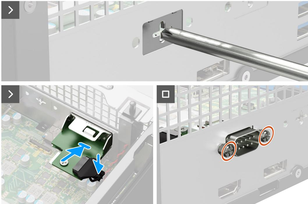
**Figura49. Instalar o módulo de série**
