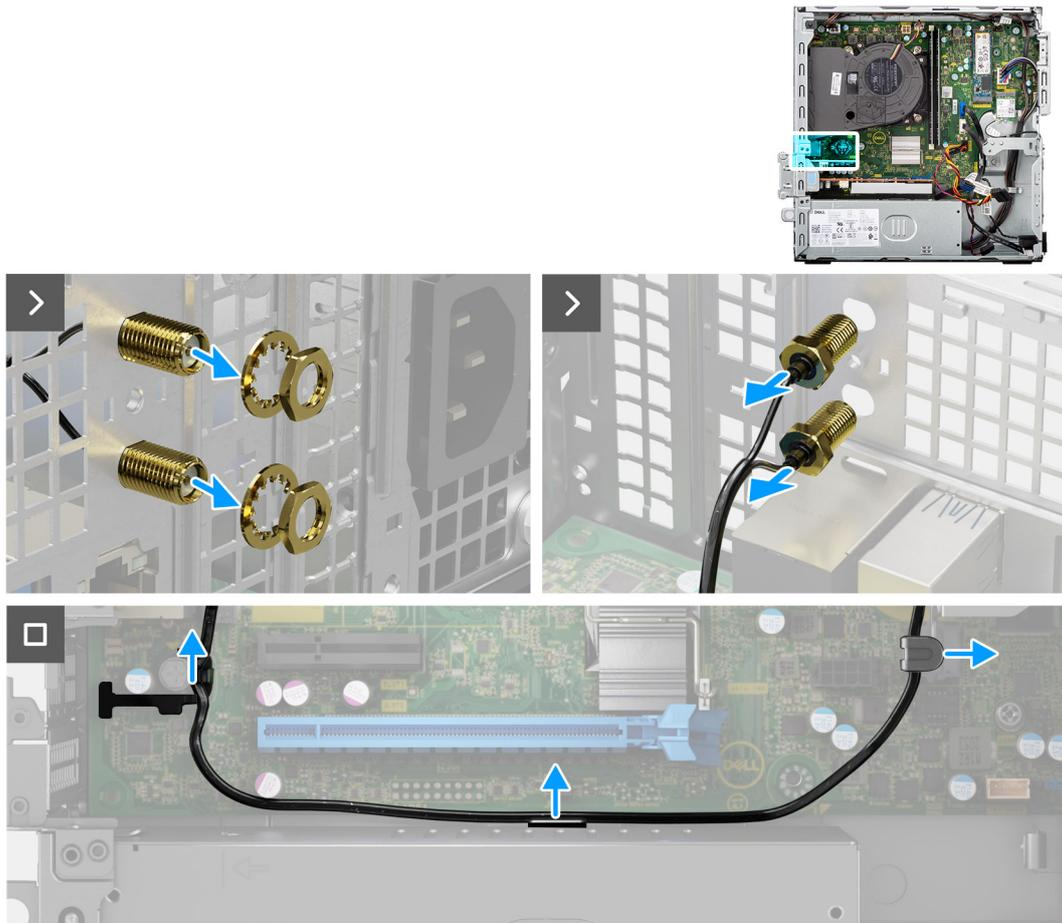
**Figura40. Retirar o módulo da antena SMA externa**
