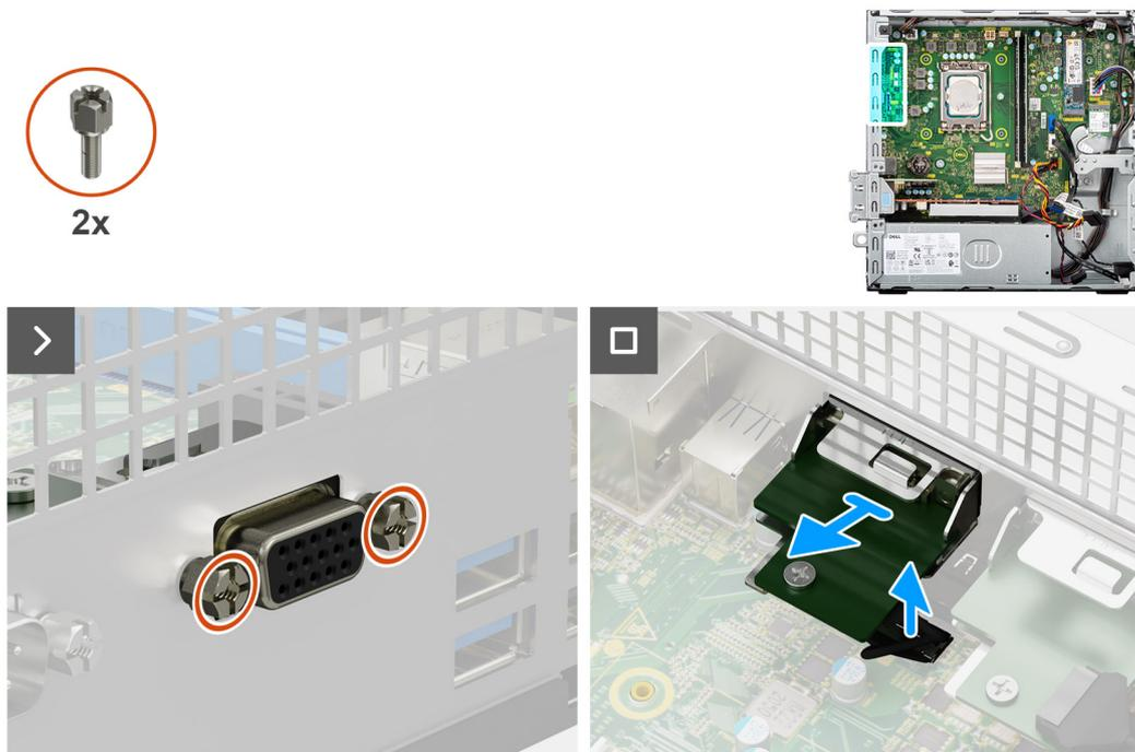
**Figura50. Retirar o módulo VGA**
