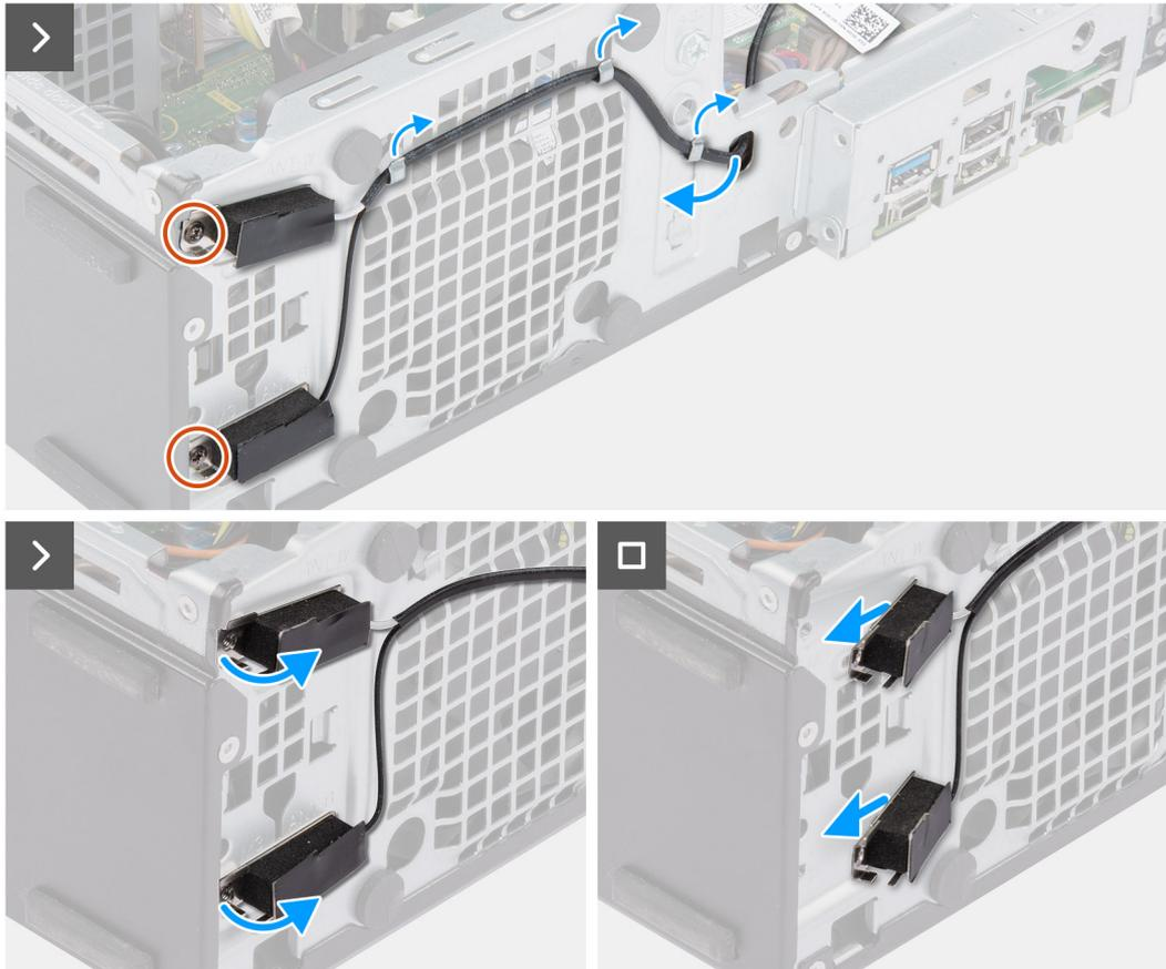
Figura37. Retirar o módulo da antena interna
