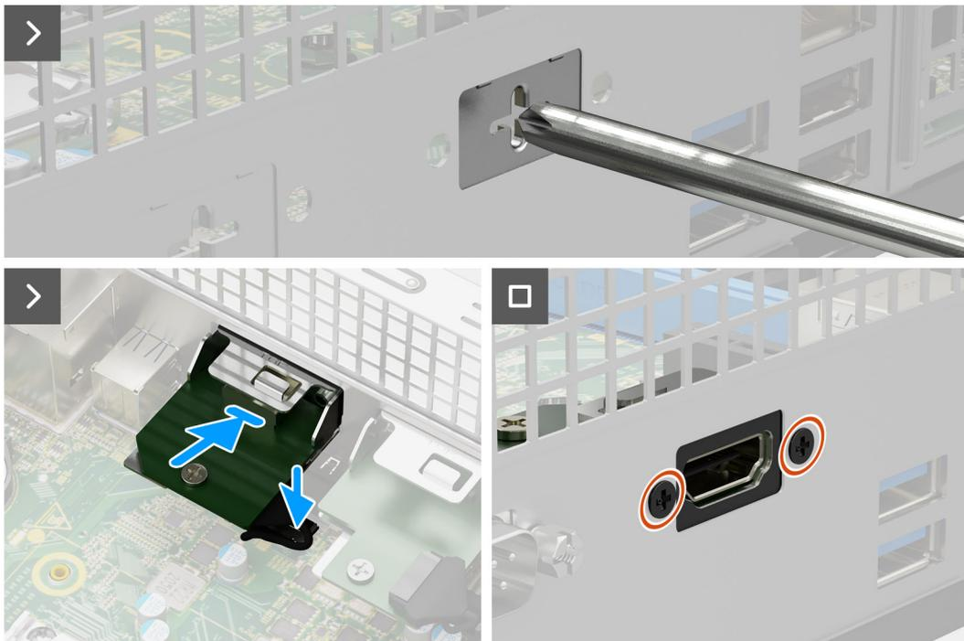
Figura55. Instalar o módulo HDMI
