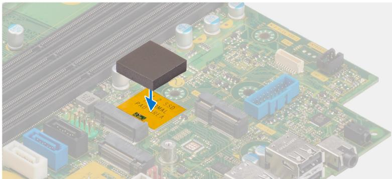
3. Descole a fita Mylar protetora no adesivo térmico.
