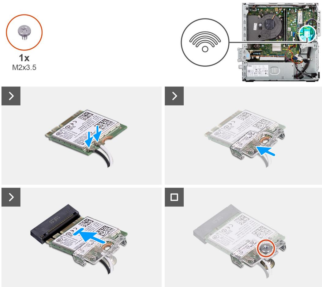
Figura28. Instalar a placa de comunicação sem fios
