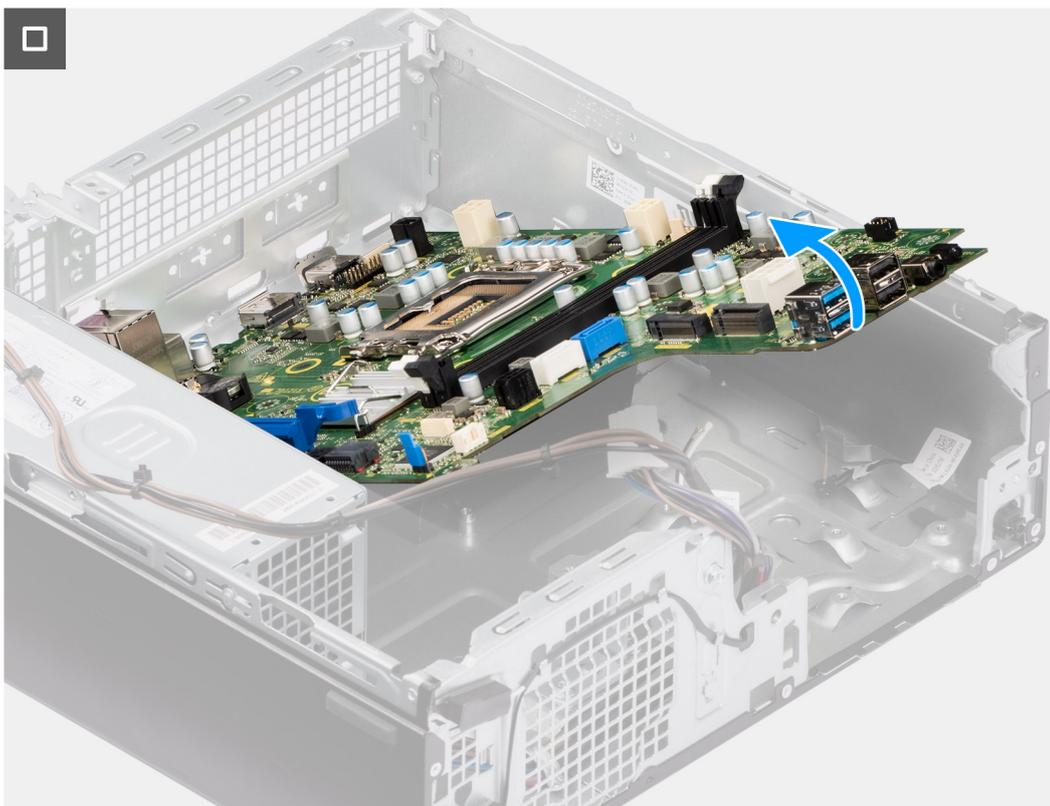
**Figura60. Retirar a placa de sistema**
