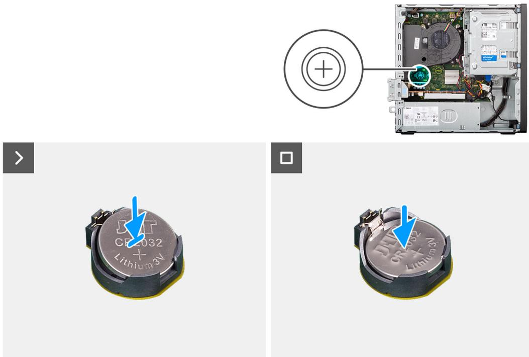
**Figura6.** Instalar a bateria de célula tipo moeda
