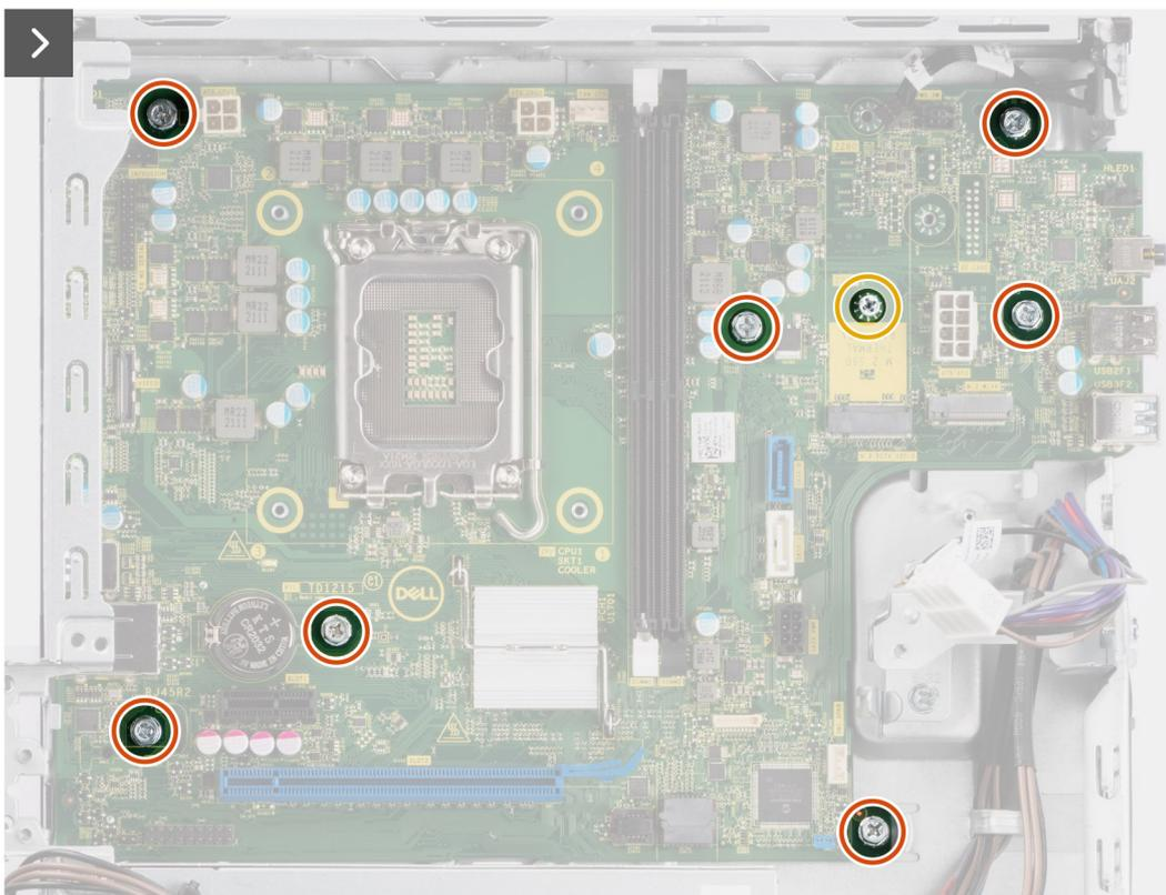
**Figura59. Retirar a placa de sistema**
