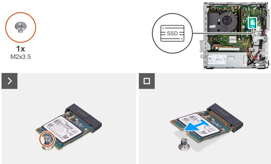
Figura17. Retirar o disco de estado sólido M.2 2230
