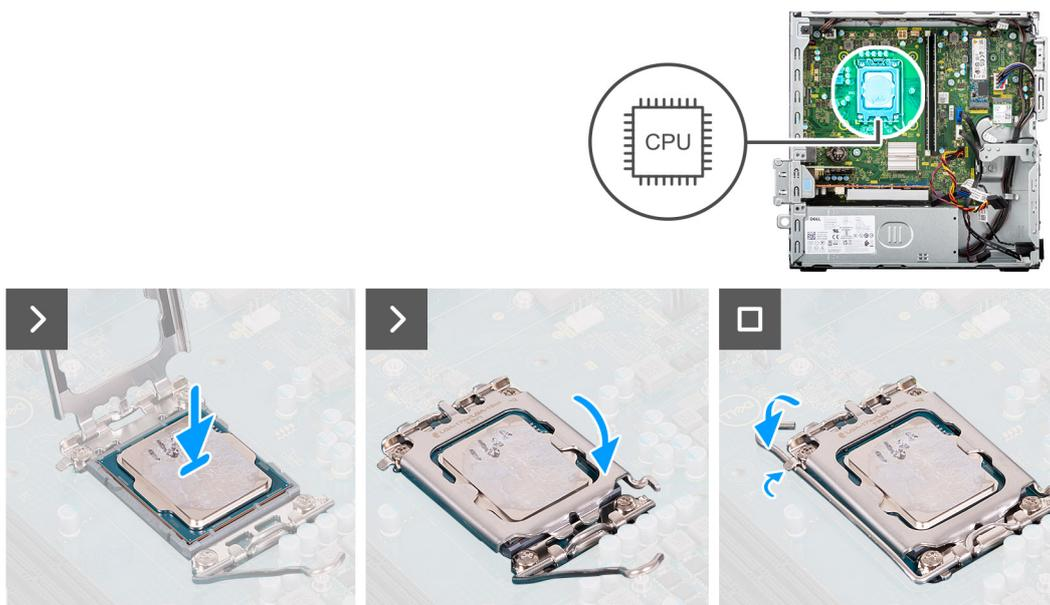
**Figura47. Instalar o processador**
