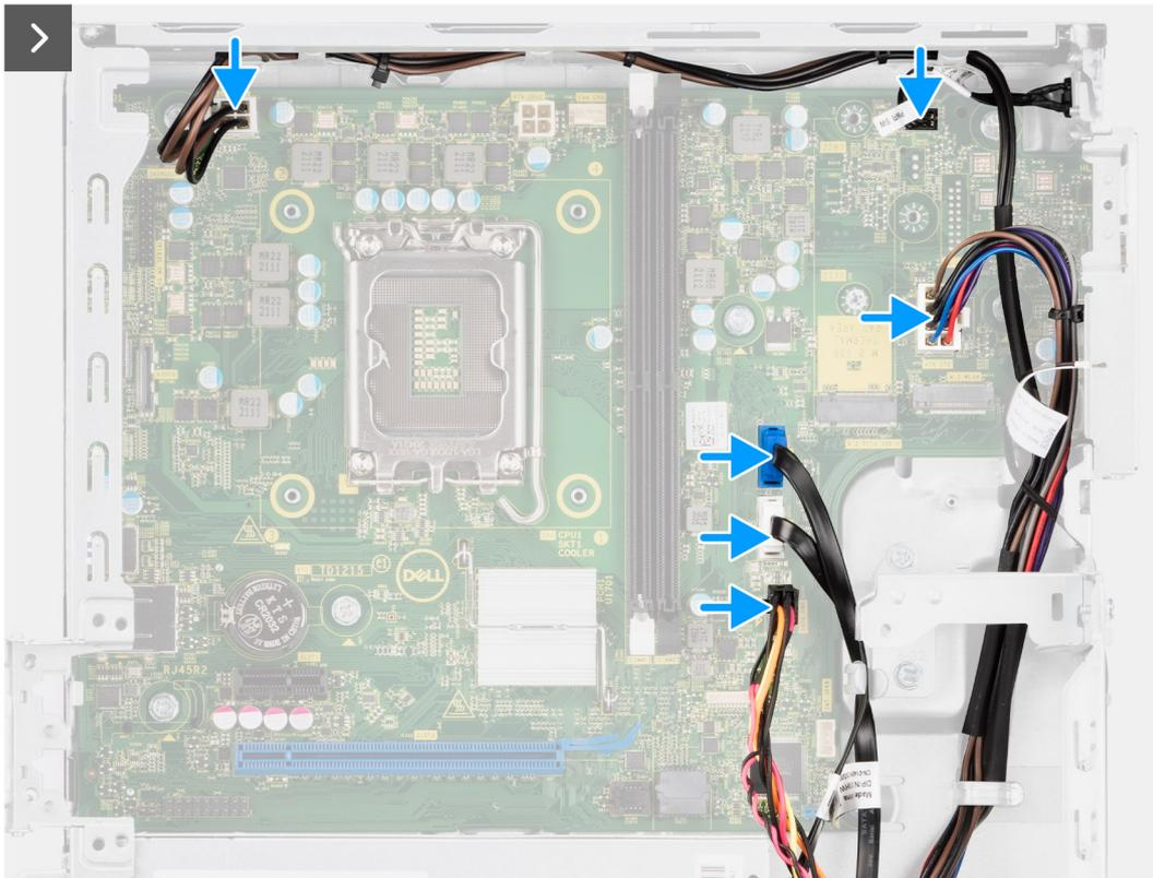
**Figura64. Instalar a placa de sistema**
