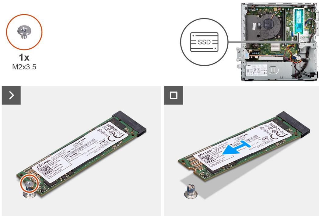
Figura19. Retirar o disco de estado sólido M.2 2280
