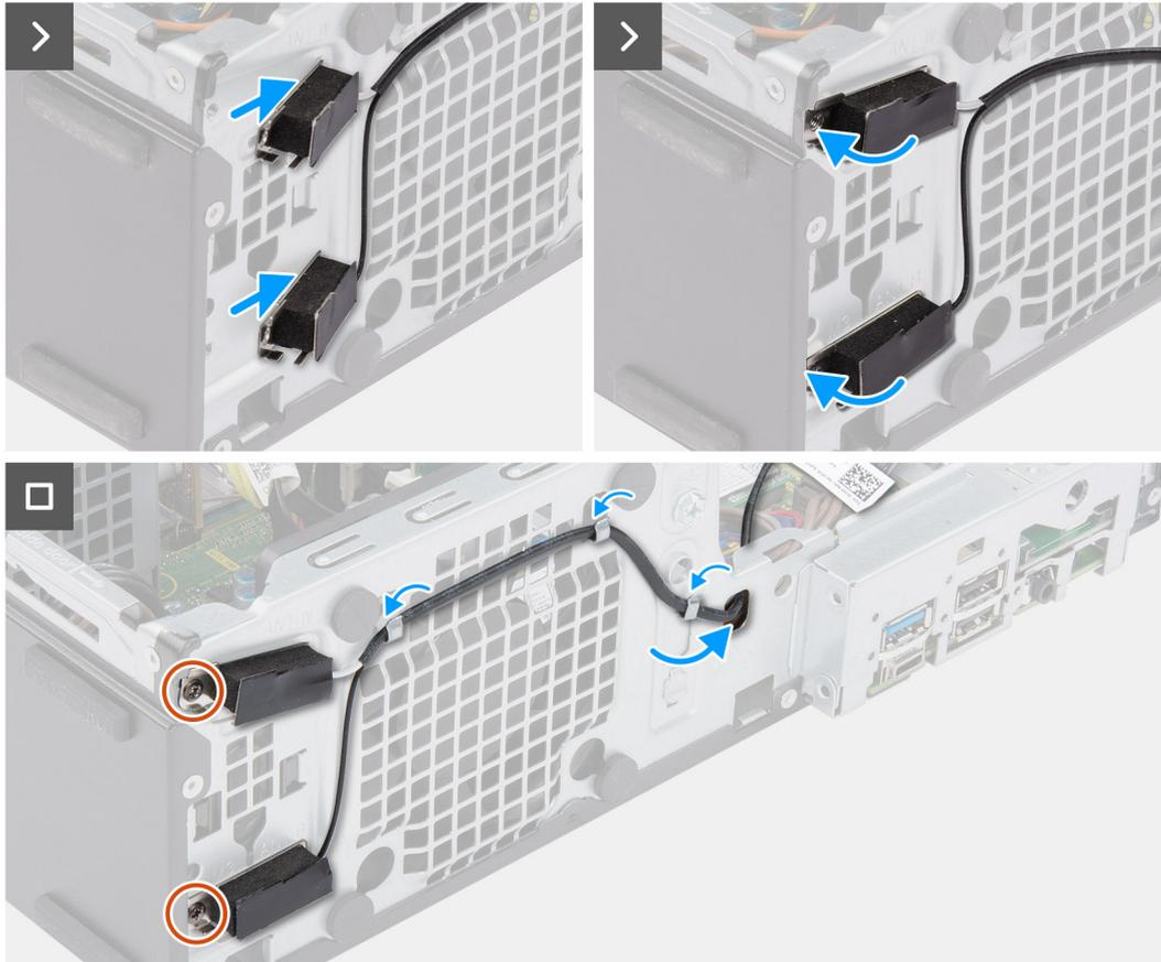
**Figura39. Instalar o módulo da antena interna**
