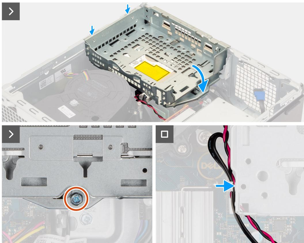
**Figura12. Instalar a caixa do disco rígido**
