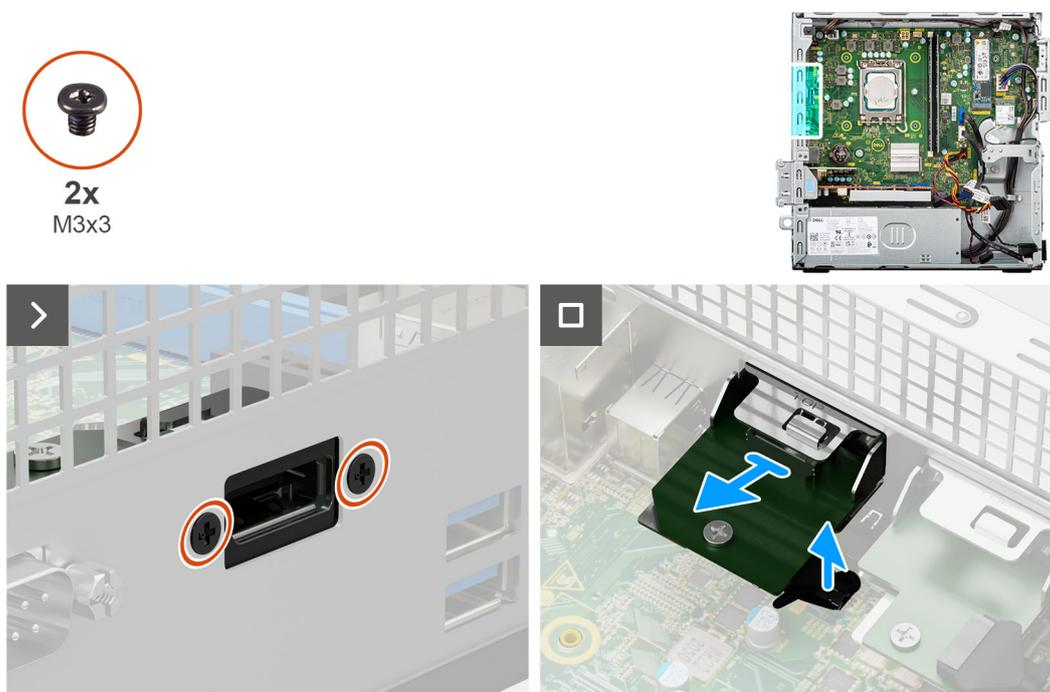
**Figura52. Retirar o módulo DisplayPort**
