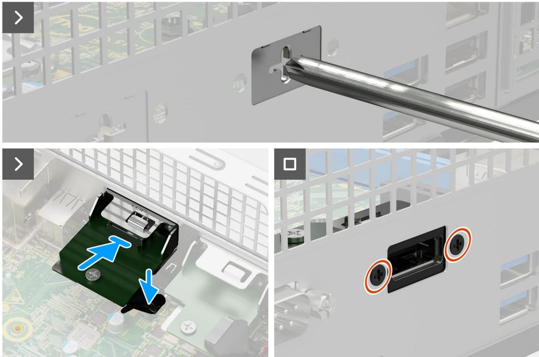
**Figura53. Instalar o módulo DisplayPort**
