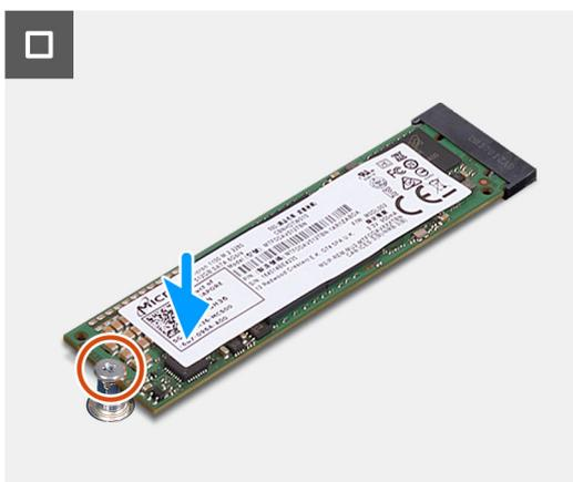
Figura20. Instalar o Disco de estado sólido M.2 2280
