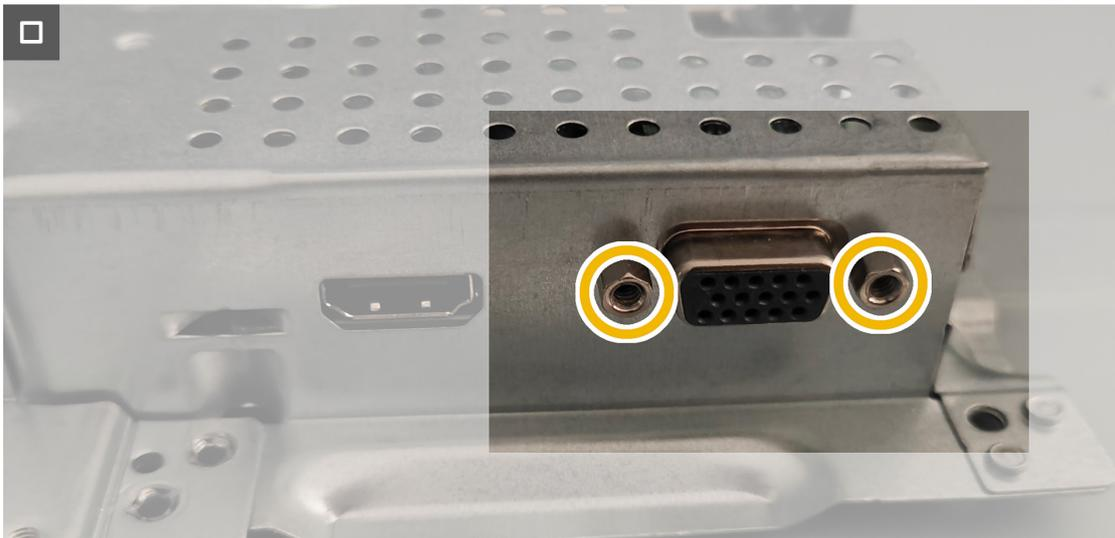
2. Volte a colar três fitas na estrutura metálica e ligue três cabos aos conectores no ecrã e na placa principal.
