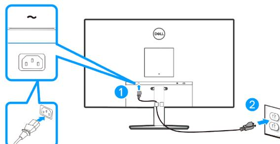
**Figure 19.** Connectez les câbles d'alimentation.
