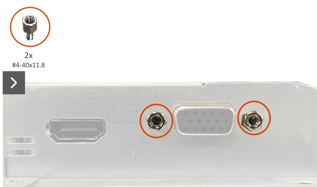
Figura 19. Remover a placa de interface
