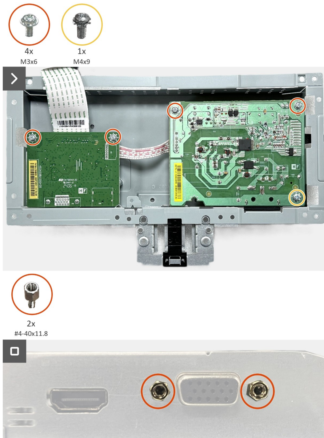
Figura 23. Instalar a placa de interface
