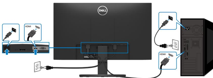
Figura 18. Ligação do cabo HDMI
