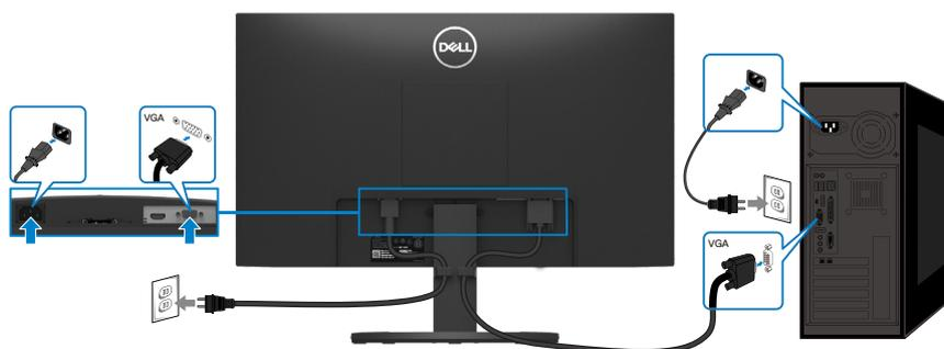
Figura 17. Ligação do cabo VGA
