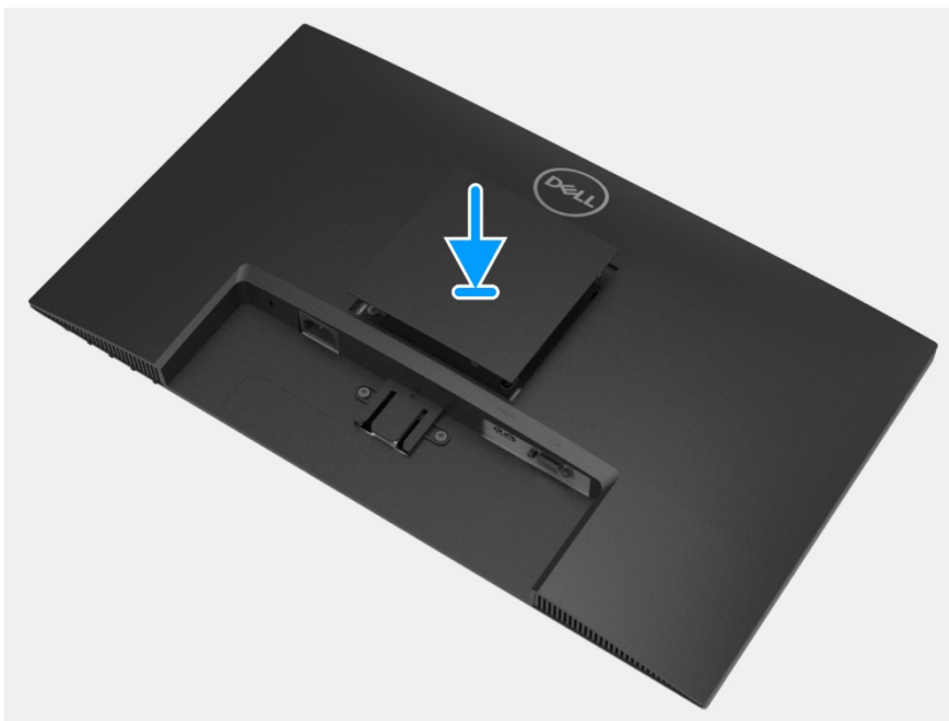
Figura 11. Installazione del coperchio VESA
