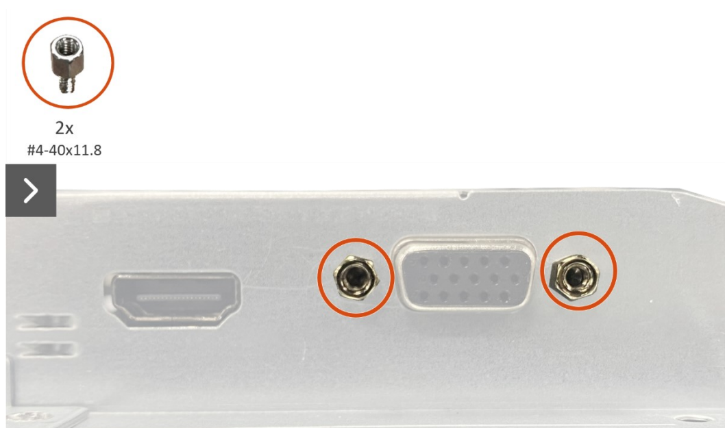
Figura 19. Rimozione della scheda di interfaccia
