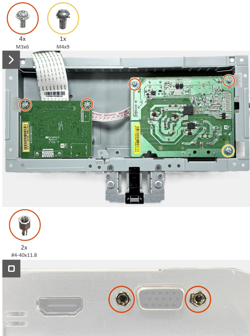
Figura 23. Installazione della scheda di interfaccia
