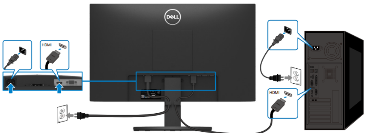
Figura 7. Collegamento del cavo HDMI
