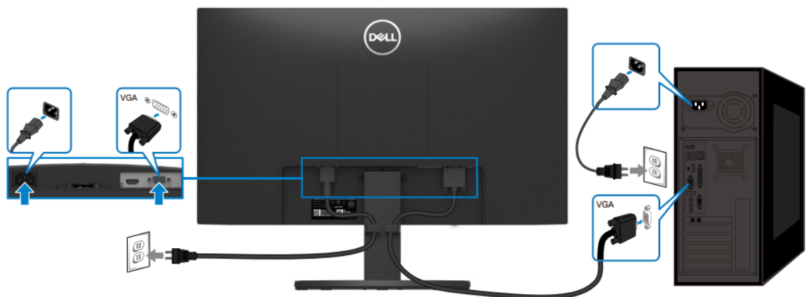
Figura 6. Collegamento del cavo VGA
