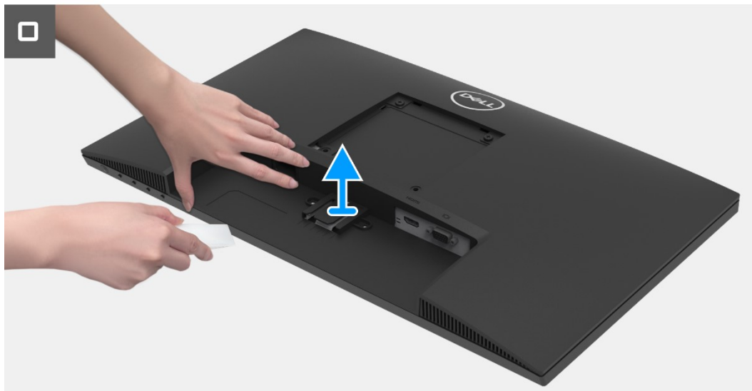
Figura 12. Rimozione del coperchio posteriore
