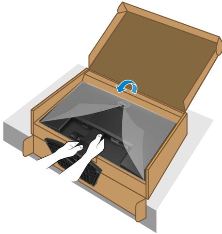
**Abbildung 15.** Halten Sie den Ständer fest und heben Sie den Monitor ab
