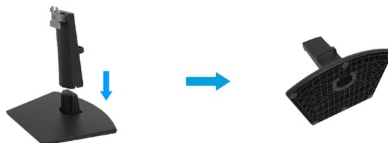
Abbildung 12. Ständer montieren
