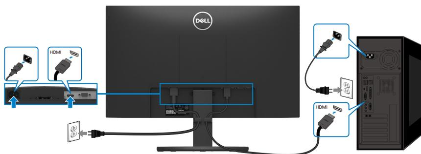
Figure 18. Connexion du câble HDMI
