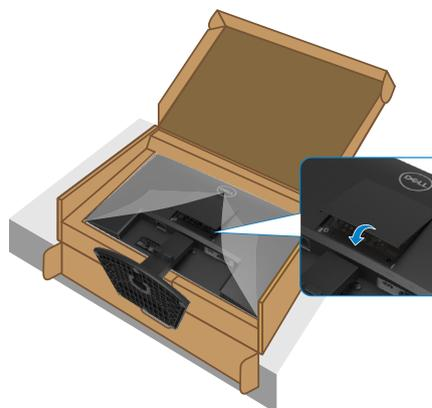
**Figura 14. Instala la cubierta VESA**
