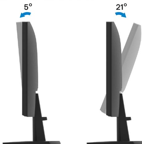
**Figura 26. Ajuste de la inclinación**
