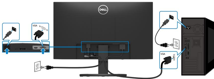
Figura 17. Conectar el cable VGA
