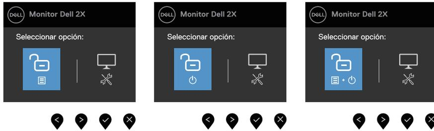
**Figura 33. Bloqueo del botón de encendido**
