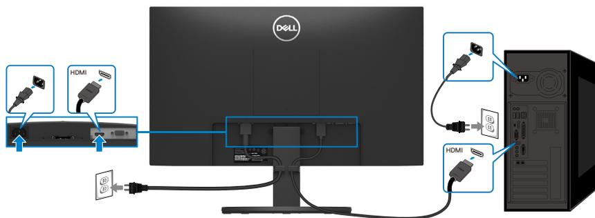
Figura 18. Conectar el cable HDMI
