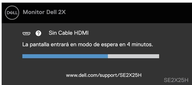
**Figura 41. Mensaje de advertencia de cable HDMI desconectado**
