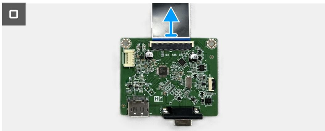
**Figura 21.** Retire la placa de la interfaz
