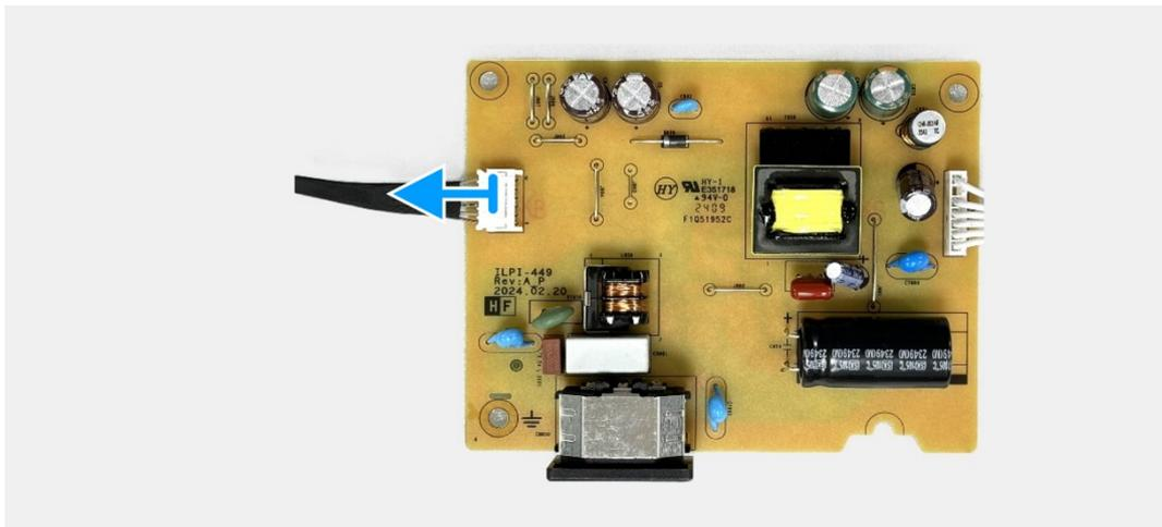
**Figura 24.** Retire la placa de alimentación
