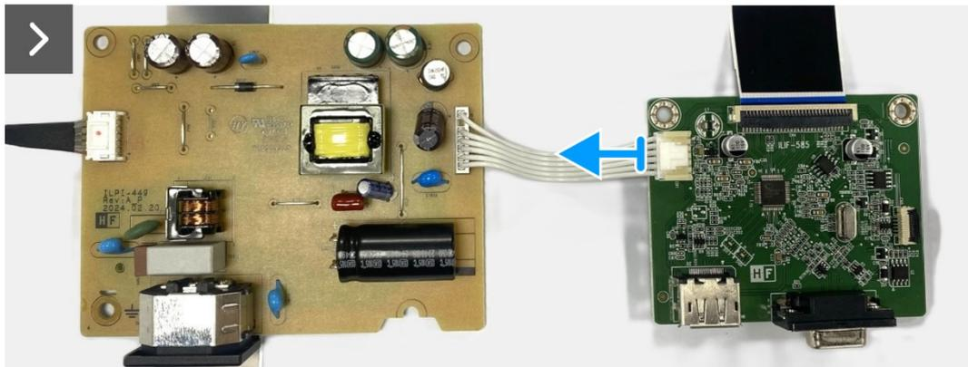
**Figura 20.** Retire la placa de la interfaz
