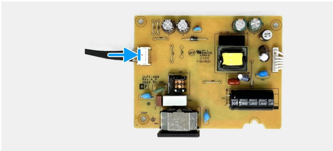
**Figura 25.** Instalar la placa de alimentación
