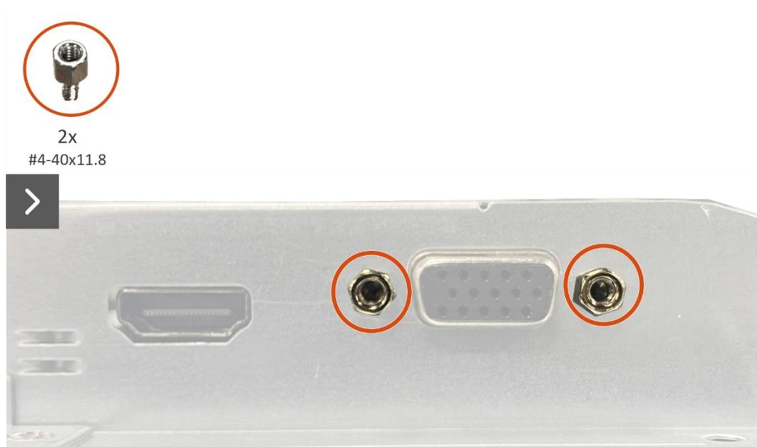
**Figura 19.** Retire la placa de la interfaz
