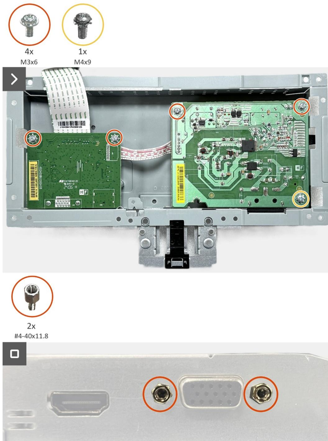
**Figura 23.** Instalar la placa de la interfaz
