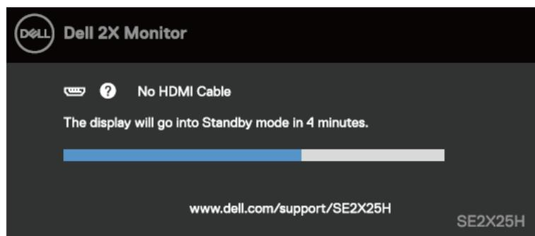
**Figura 27.** Mensaje de advertencia de cable HDMI desconectado
