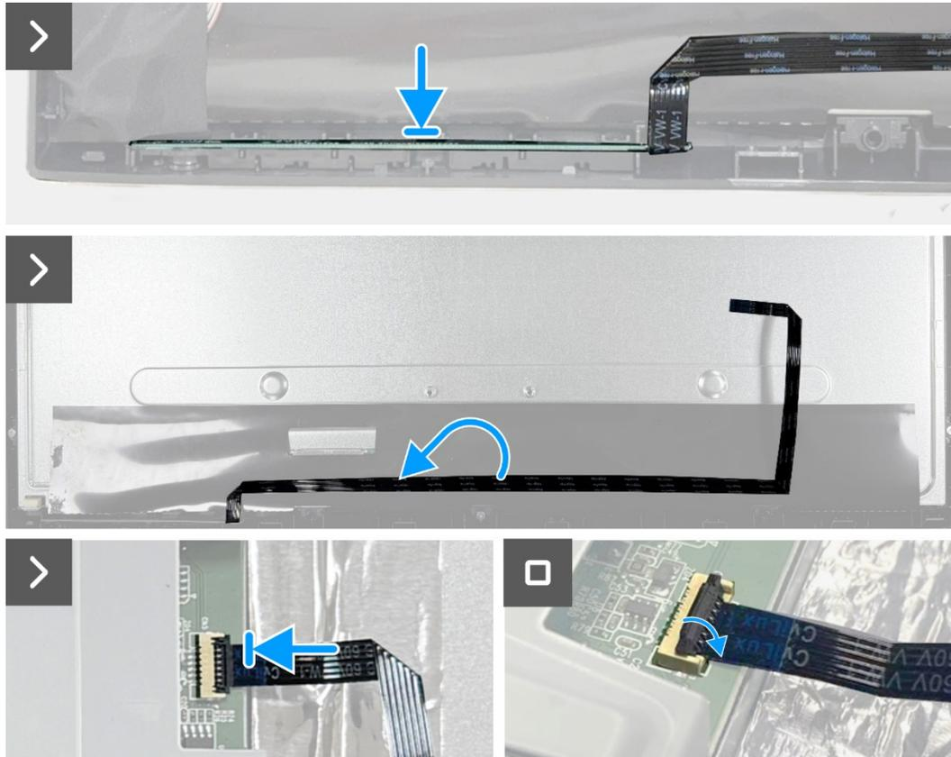
Figura 15. Instalar la placa del teclado
