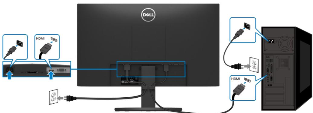
Figura 7. Conectar el cable HDMI
