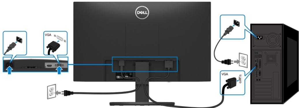
Figura 6. Conectar el cable VGA
