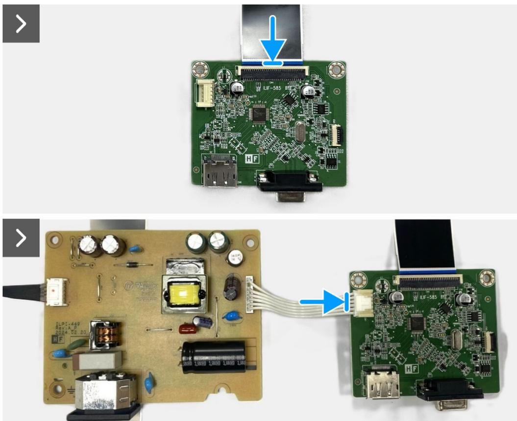
**Figura 22.** Instalar la placa de la interfaz
