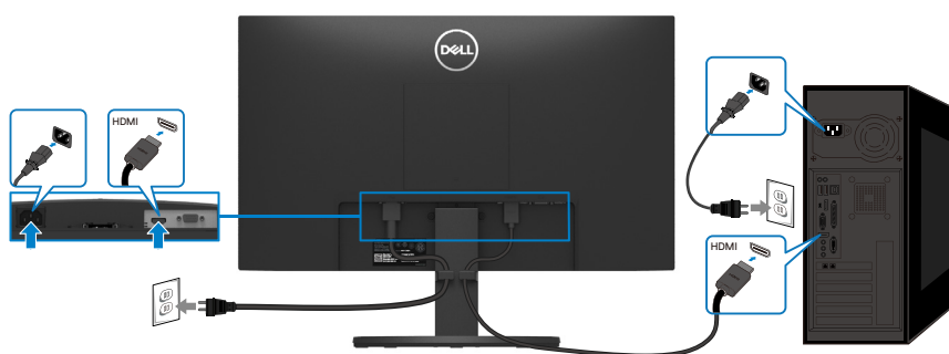
Obrázek 18. Připojení kabelu HDMI
