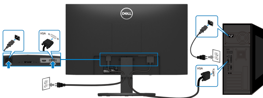
Obrázek 17. Připojení kabelu VGA
