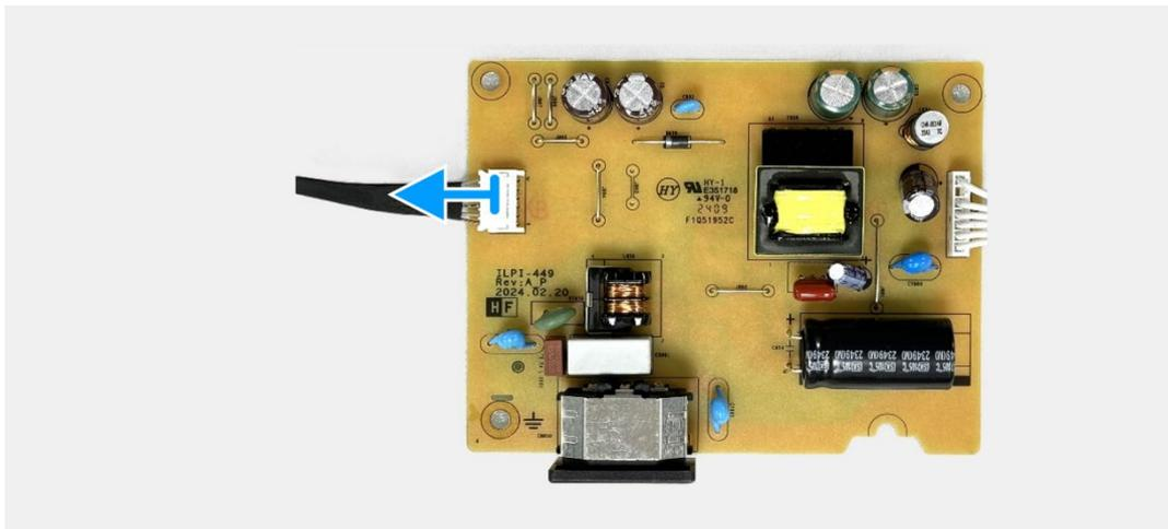
**Figura 25.** Remover a placa de alimentação
