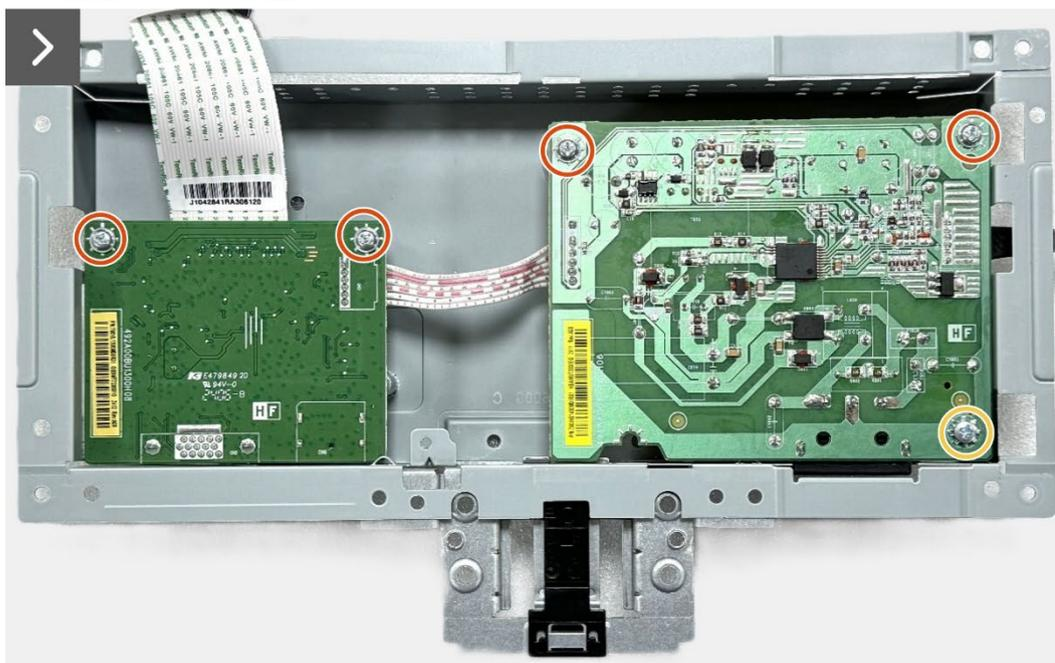
**Figura 21.** Remover a placa de interface
