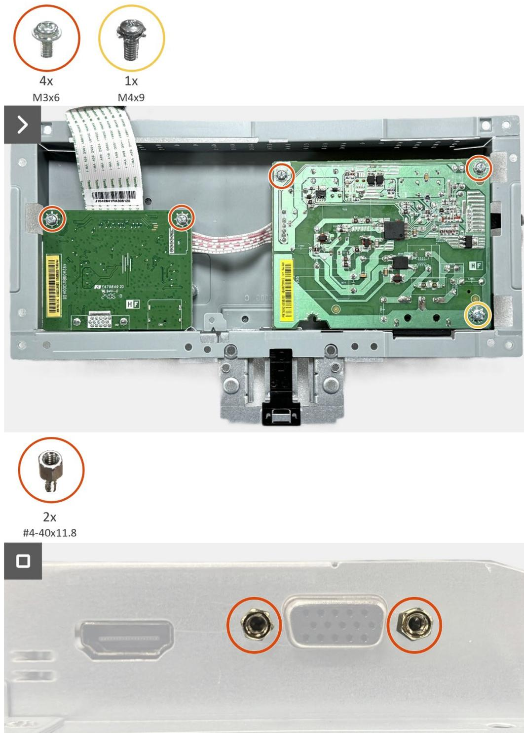
**Figura 24.** Instalar a placa de interface
