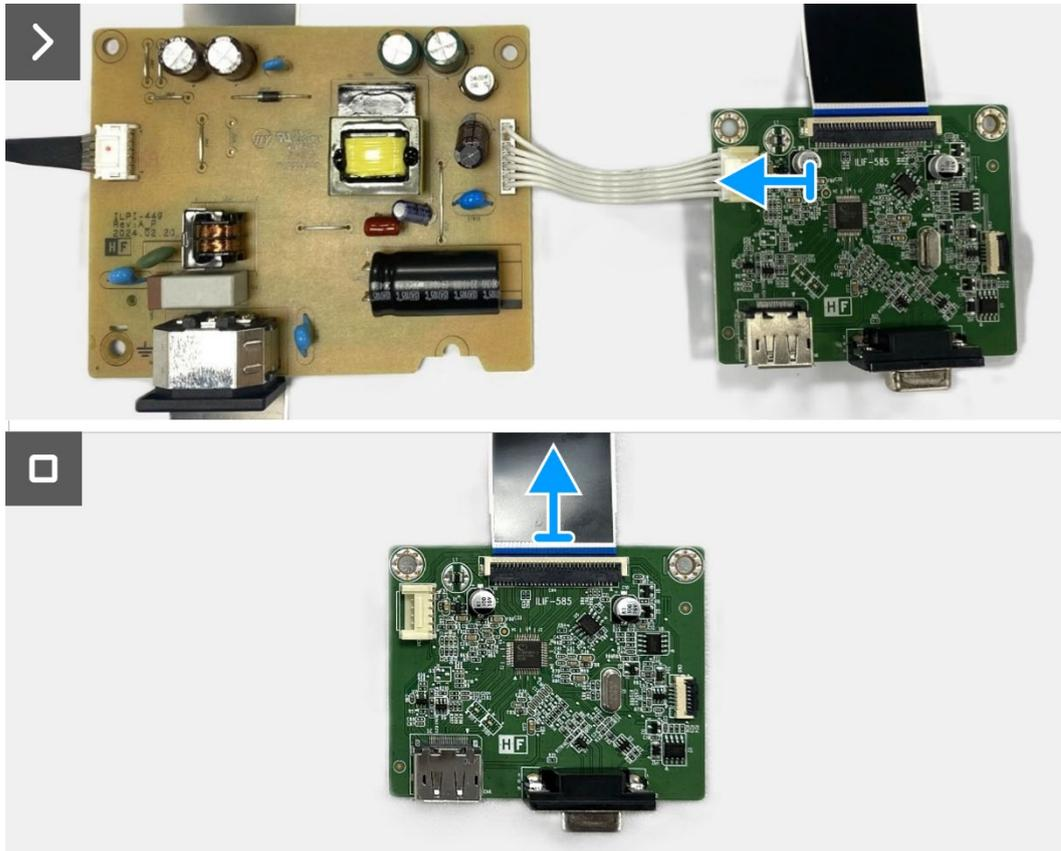
**Figura 22.** Remover a placa de interface
