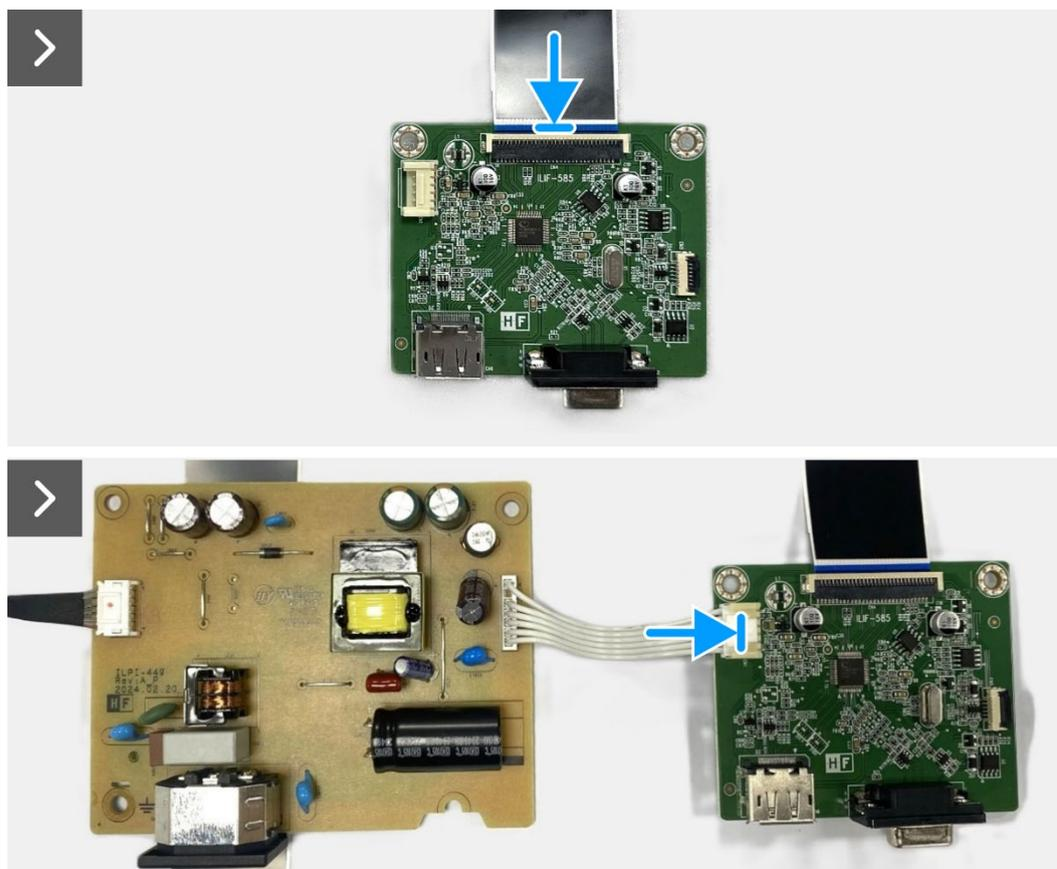
**Figura 23.** Instalar a placa de interface
