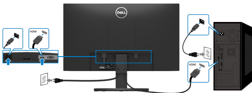
Abbildung 18. Anschließen des HDMI-Kabels
