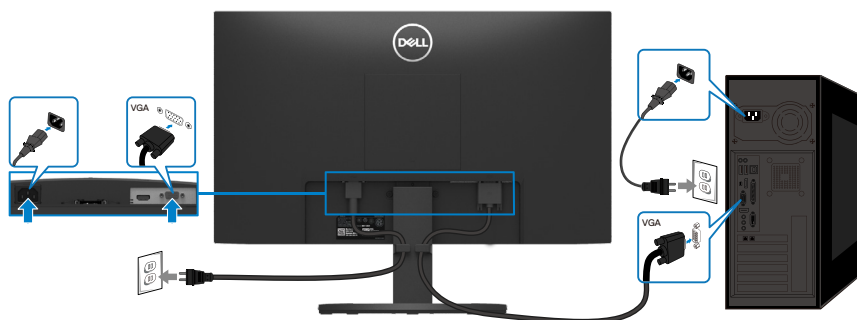
Figure 17. Connexion du câble VGA
