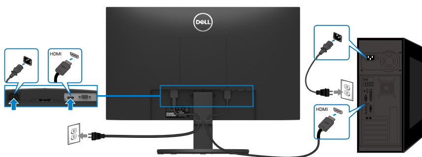
Figure 18. Connexion du câble HDMI
