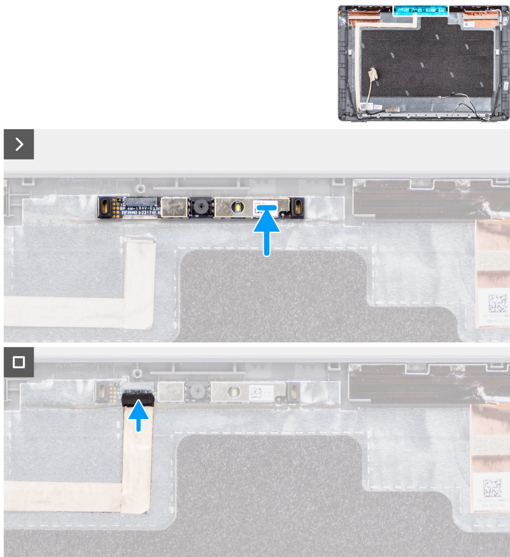
Figure 65. Installation de la caméra
