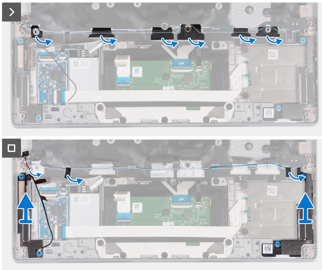
Afbeelding 52. De luidsprekers verwijderen
