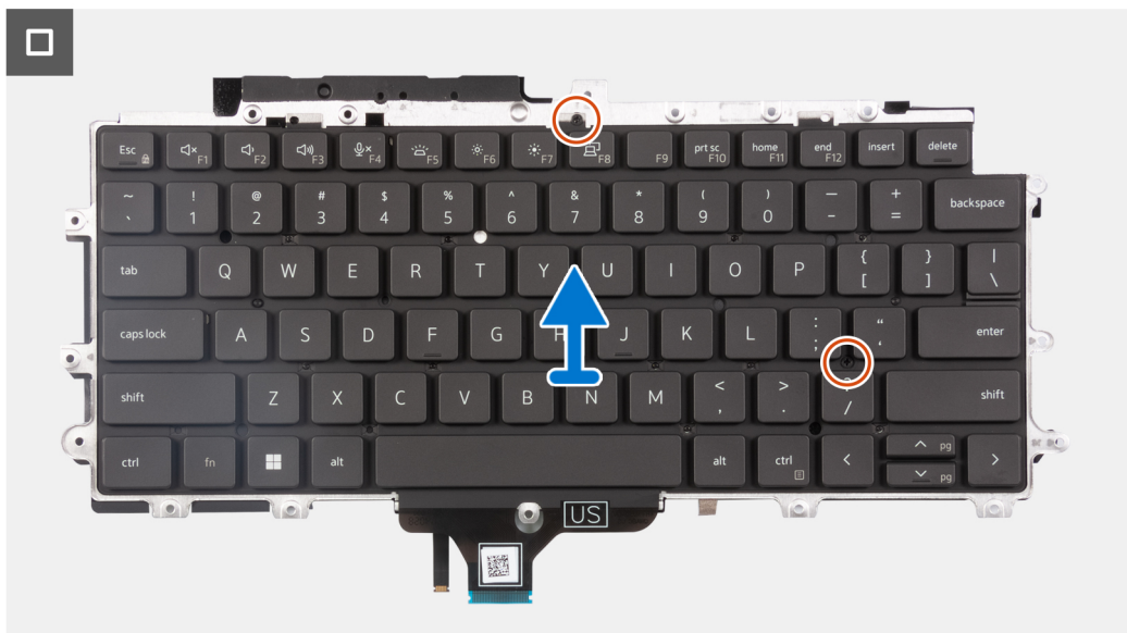
Afbeelding 60. De toetsenbordeenheid verwijderen
