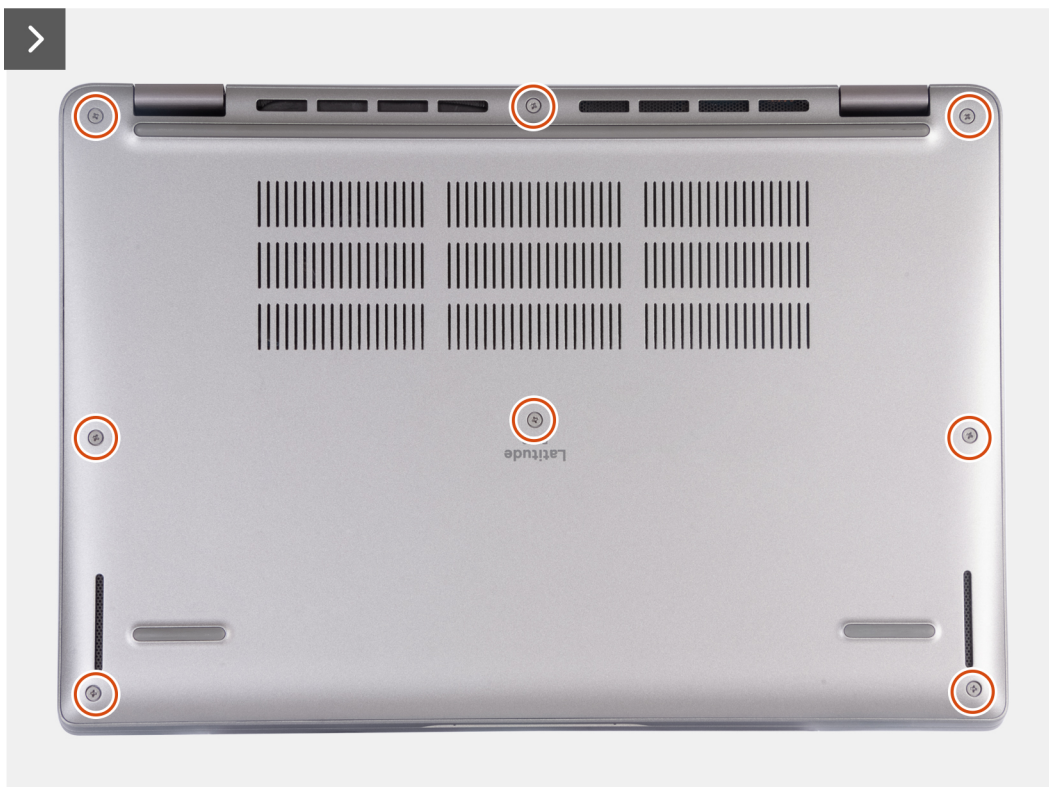
Afbeelding 17. Draai de acht geborgde schroeven los waarmee de onderplaat aan de palmsteuneenheid is bevestigd
