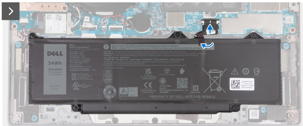
Afbeelding 20. De batterijkabel op de systeemkaart aansluiten
