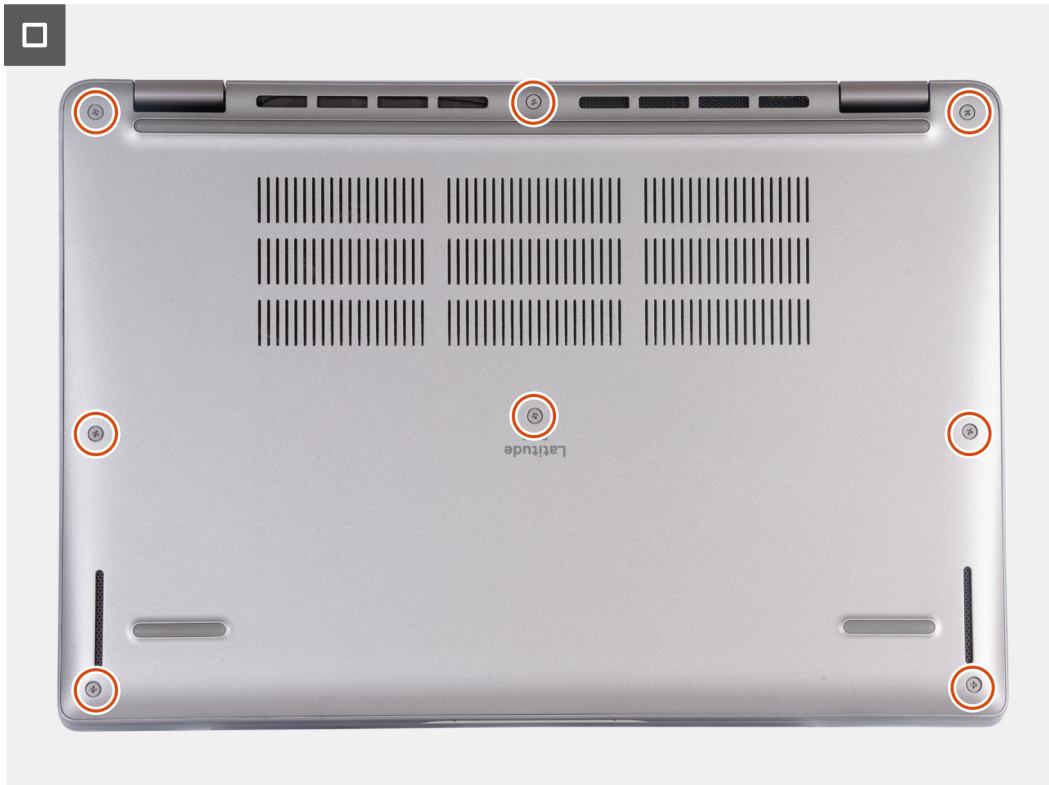
Afbeelding 22. Draai de acht geborgde schroeven vast om de onderplaat aan de palmsteuneenheid te bevestigen
