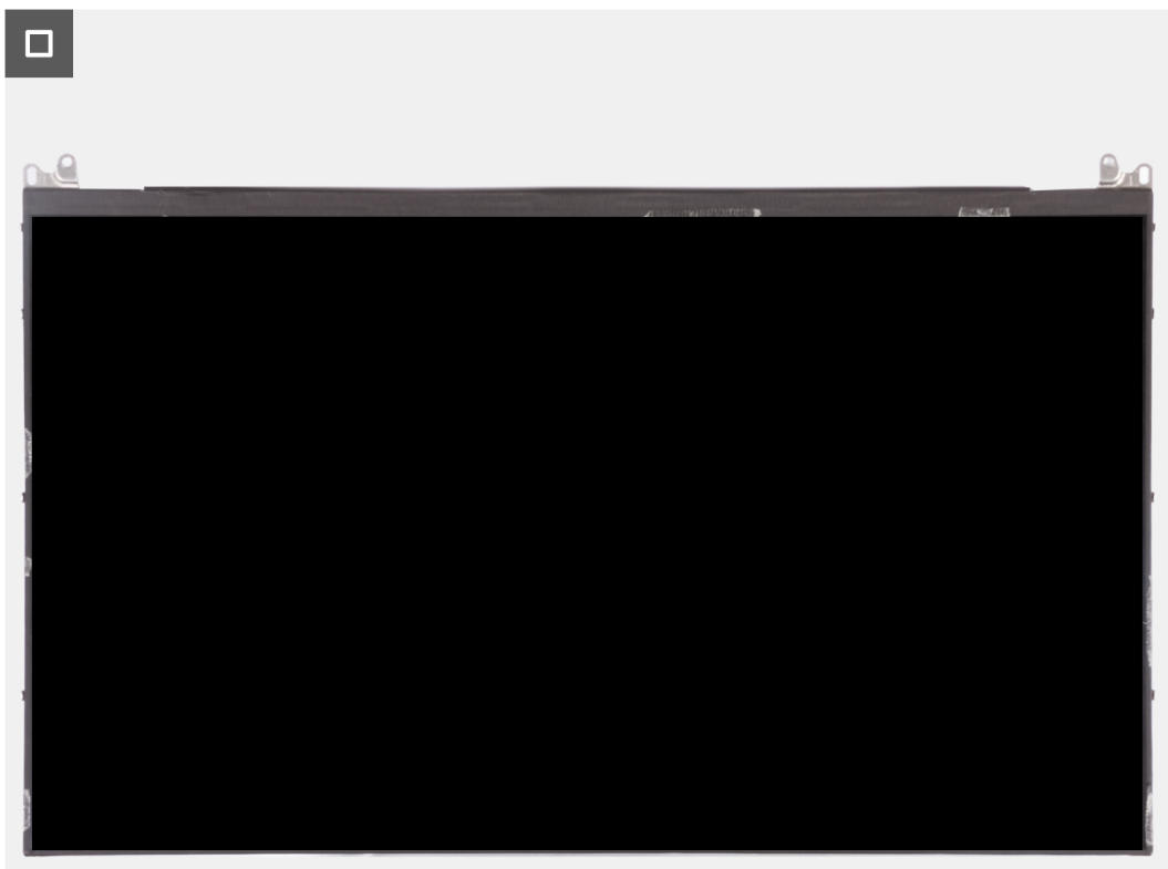
Afbeelding 76. Het beeldschermpaneel verwijderen (laptop)
