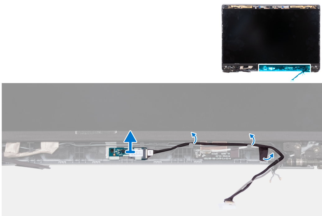
Afbeelding 86. De sensorkaart verwijderen (laptop)
