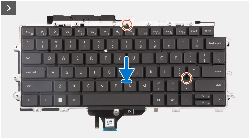
Afbeelding 61. De toetsenbordeenheid installeren
