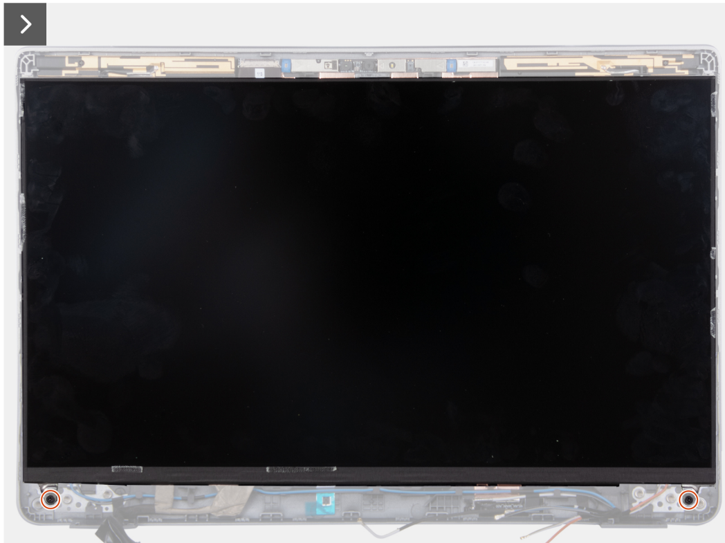
Afbeelding 72. Het beeldschermpaneel verwijderen (laptop)
