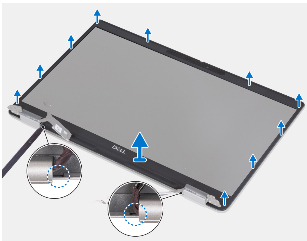
Figure 67. Retrait de la bordure d'écran (ordinateur portable)
