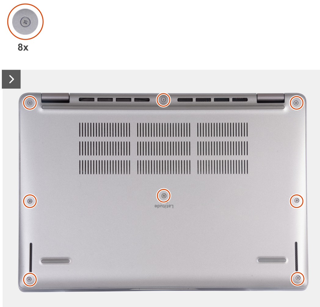
Figure 17. Dévissez les huit vis imperdables qui fixent le cache de fond à l'assemblage du repose-poignets
