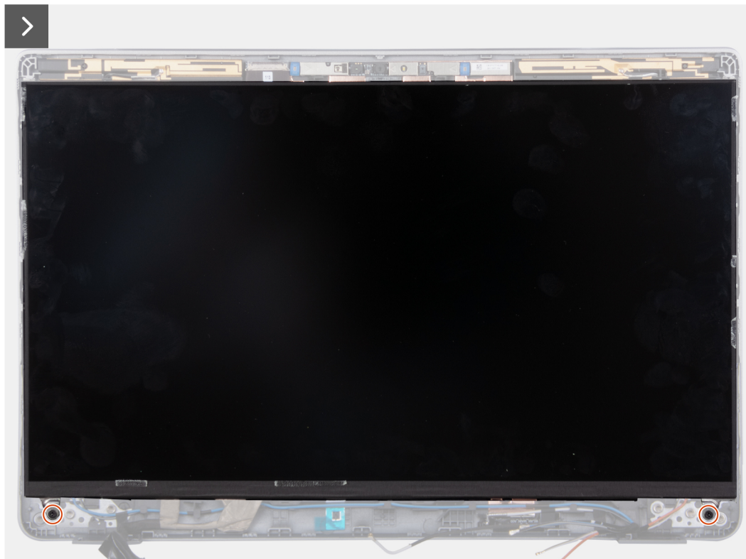
Figure 72. Retrait du panneau d'écran (ordinateur portable)
