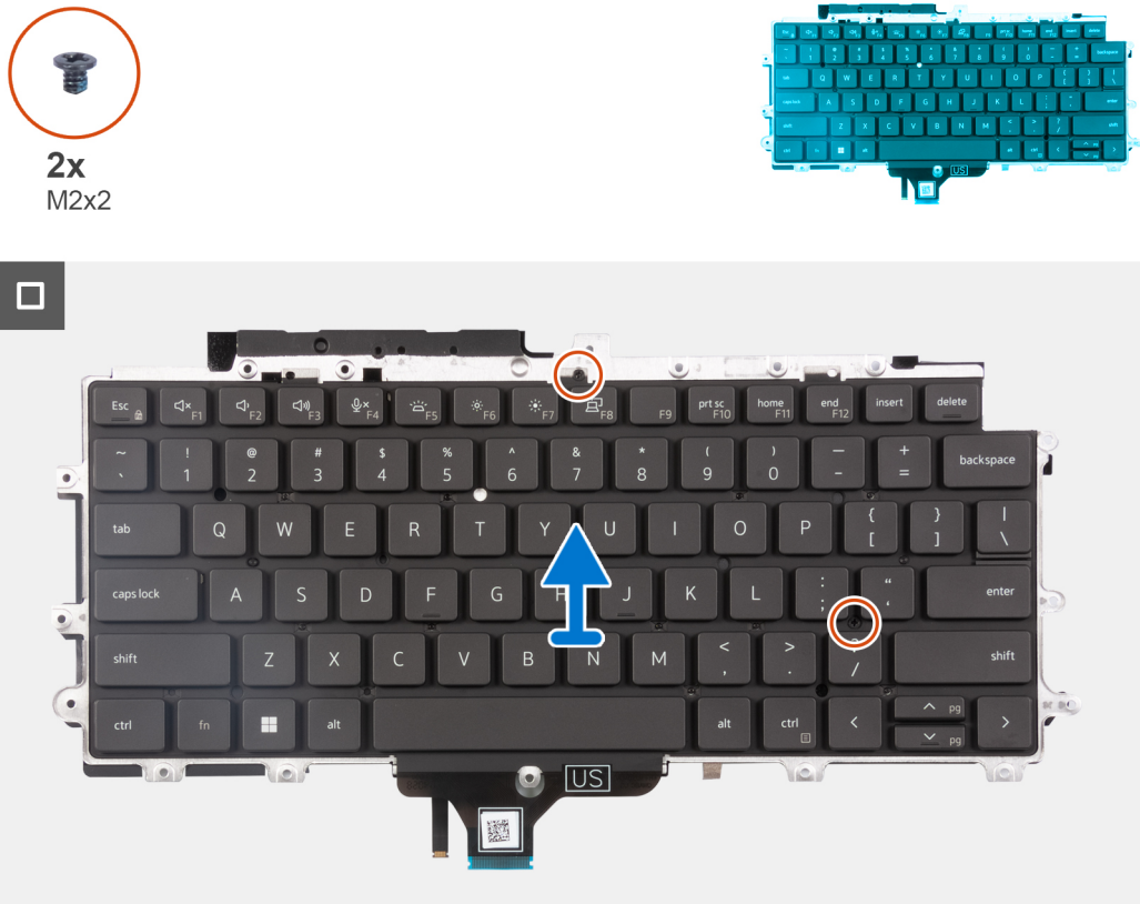
Figure 60. Retrait de l'assemblage du clavier
