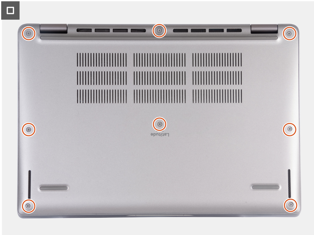
Figure 22. Vissez les huit vis imperdables pour fixer le cache de fond à l'assemblage du repose-poignets
