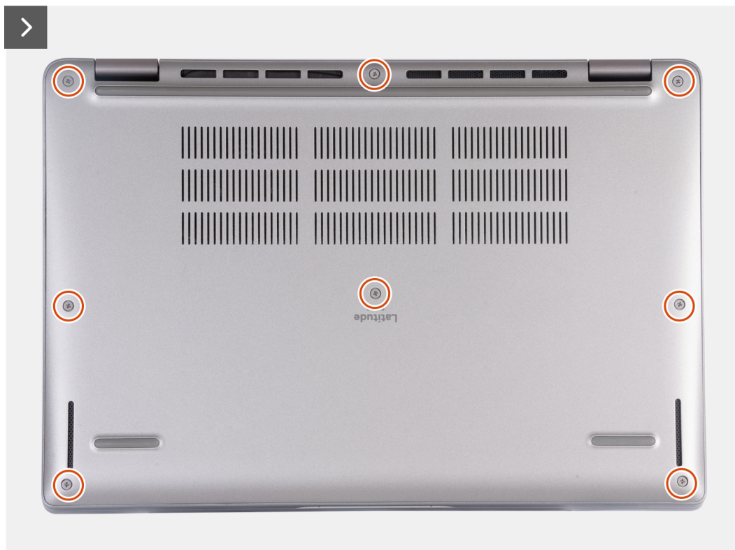
Abbildung 17. Lösen der acht unverlierbaren Schrauben, mit denen die Bodenabdeckung an der Handauflagenbaugruppe befestigt ist
