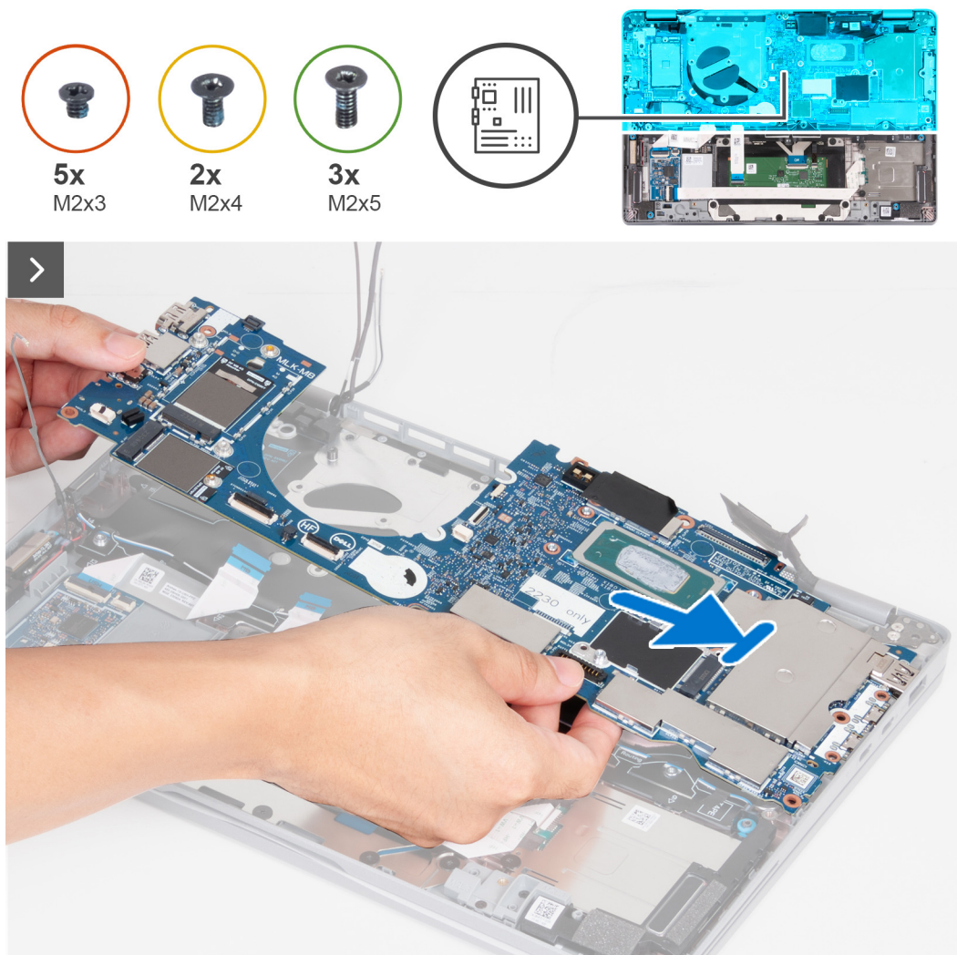
Abbildung 49. Einbauen der Systemplatine
