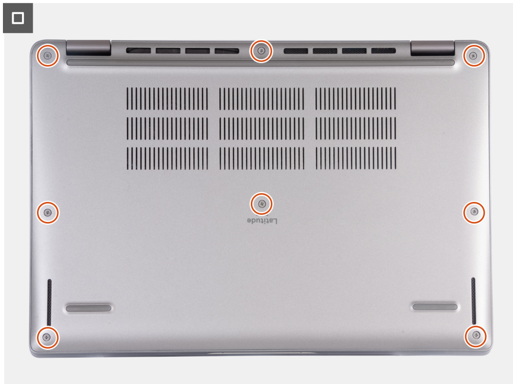
Abbildung 22. Festziehen der acht unverlierbaren Schrauben zum Befestigen der Bodenabdeckung an der Handauflagenbaugruppe
