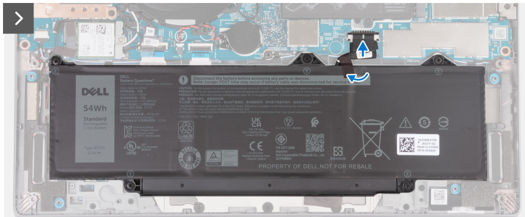
Abbildung 20. Verbinden Sie das Batteriekabel mit der Systemplatine
