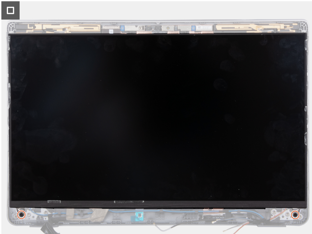
Abbildung 79. Einsetzen der Laschen des Bildschirms in die Schlitzes der Bildschirmabdeckung
