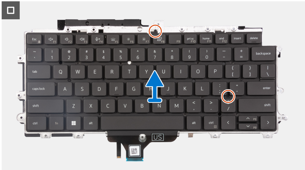
Abbildung 60. Entfernen der Tastaturbaugruppe
