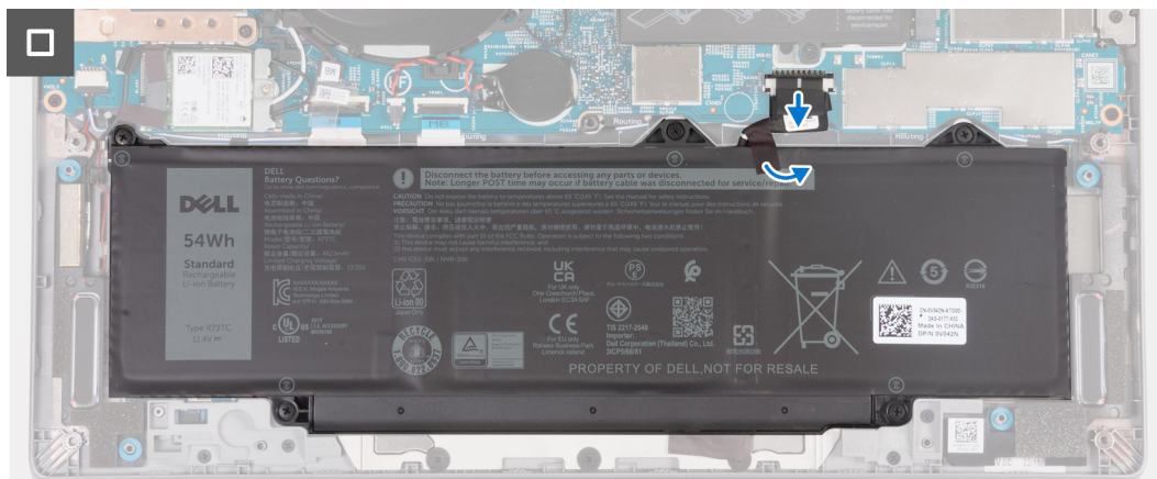
Abbildung 19. Trennen des Akkukabels von der Hauptplatine
