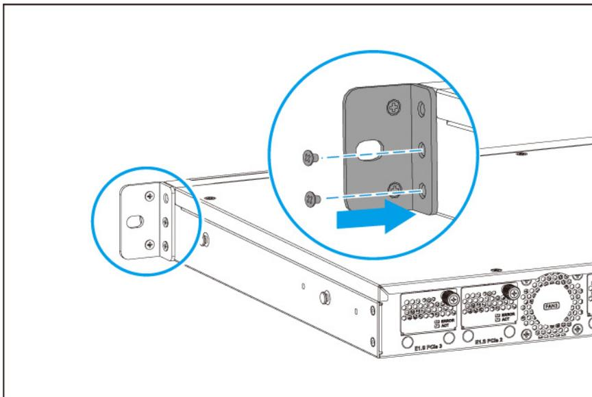
3. Installieren Sie einen zweiten Griff auf der anderen Seite des Gehäuses.
