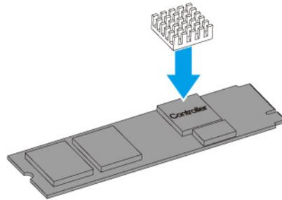
3. Optional: Bringen Sie ein oder mehrere Thermo-Pads auf dem Laufwerksträger an.
