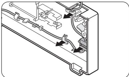
3. Rimuovere il cavo ed il connettore situato sul fermo al di sotto del coperchio.
