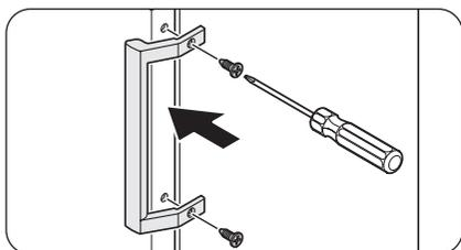
4. Posizionare la maniglia sul lato opposto della porta ed usando un cacciavite a croce rifissare le viti.
