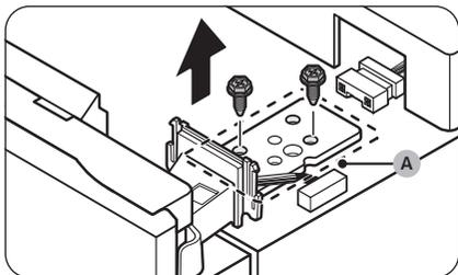
5. Usare una chiave a bussola (8 mm) per rimuovere le viti che fissano la **cerniera superiore (A)**.
