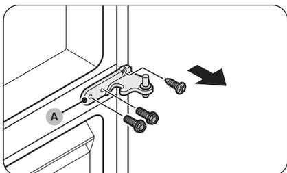
9. Usare un cacciavite a croce ed una chiave a bussola (10 mm) per rimuovere le viti che fissano la **cerniera centrale (A)**.
