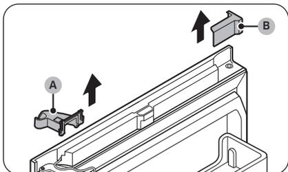
23. Rimuovere il **copercchio della cerniera superiore destra (A)** ed il **copercchio della cerniera superiore sinistra (B)**.
