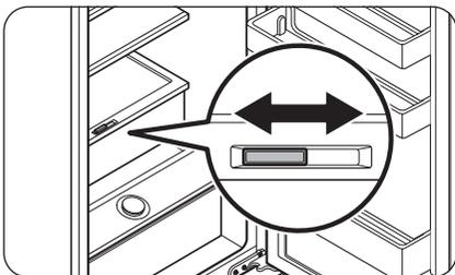
Il cassetto Fresco ottimale+ permette la suddivisione dell'area in due zone separate mediante il Divisorio flessibile.
