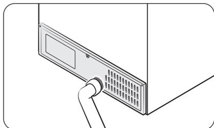
Per mantenere cavi e parti esposte del retro del pannello puliti, aspirare il pannello una o due volte l'anno.
