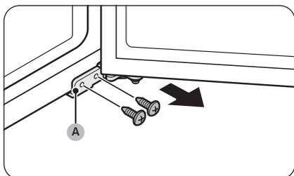
7. Aprire la porta del freezer ed usare un cacciavite a croce per rimuovere le viti che fissano la **cerniera inferiore (A)**.
