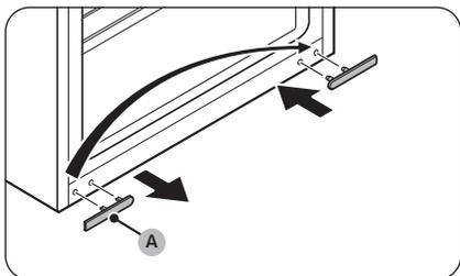
12. Rimuovere il **coperchio della vite della cerniera inferiore (A)** e posizionarlo sul lato opposto.
