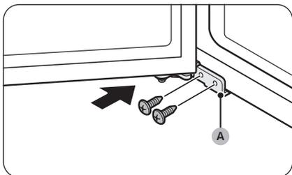
19. Usare una cacciavite a croce per serrare la **cerniera inferiore (A)** con le viti. Chiudere lo sportello del freezer.
