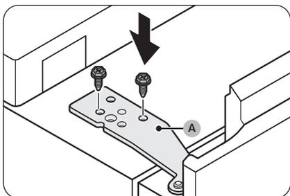
29. Fissare la **cerniera superiore (A)** con le viti usando una chiave a bussola (8 mm).
