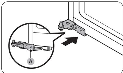
17. Ruotare il piedino di livellamento sul lato opposto dal quale è stata rimossa la **cerniera inferiore (A)**. Quindi, posizionare la **cerniera inferiore (A)** sul fermo.
