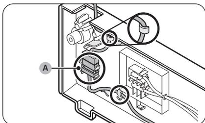
34. Posizionare il cavo ed il **connettore del cavo (A)** situato sul fermo al di sotto del coperchio.
