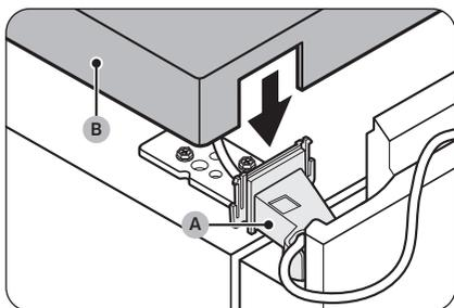
35. Fissare il **coperchio della cerniera superiore sinistra (A)** alla cerniera superiore e montare il **coperchio superiore (B)**.
