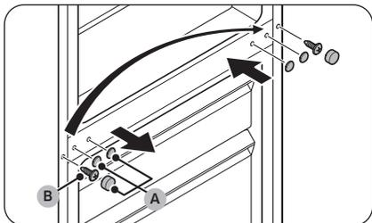
10. Rimuovere i **coperchi delle viti della cerniera centrale (A)**, quindi usare un cacciavite a croce per rimuovere la **vite (B)**.
