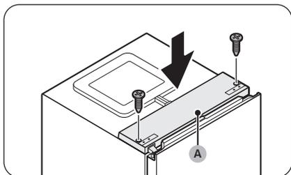
36. Con la porta del frigorifero chiusa, inserire nuovamente il **coperchio superiore (A)** e fissarlo con le viti usando un cacciavite a croce.
