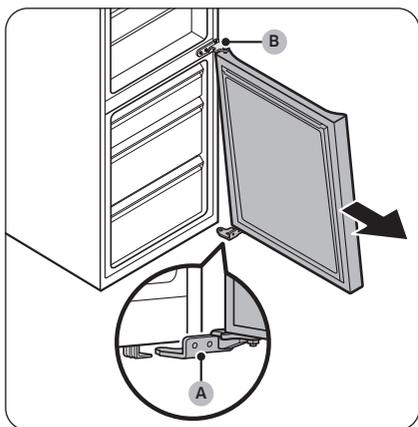
8. Tenendo la porta del freezer appoggiata sulla **cerniera inferiore (A)**, tirare lentamente la **cerniera inferiore (A)** per estrarla dal fermo posto sul fondo del frigorifero. Una volta rimossa la **cerniera inferiore (A)** dal fermo, rimuoverla dalla porta del freezer, quindi tirare la porta del freezer verso il basso per rimuoverla dalla **cerniera centrale (B)**.
