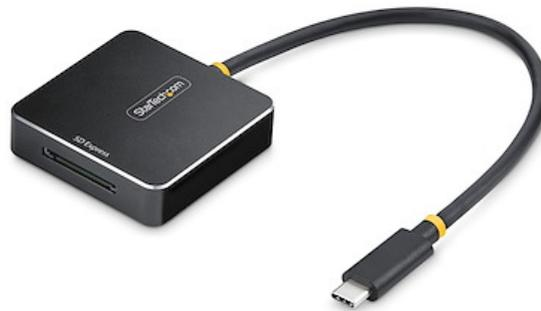
Este lector de tarjetas SD Express le permite conectar una tarjeta SD Express (PCIe 3.1 x1) a cualquier ordenador portátil, de sobremesa, tablet u otro dispositivo compatible con USB-C para la transferencia de datos a alta velocidad de imágenes o vídeo de alta resolución.
