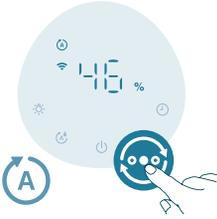
**Режим за сън (C)**: Овлажнителят работи тихо на ниска скорост. След 3 секунди светлините на екрана се изключват.
