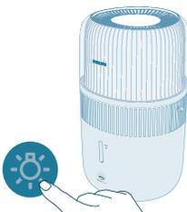
Stlačením tlačidla svetla môžete vypnúť všetky svetlá a ovládací panel. Stlačením ľubovoľného tlačidla najskôr panel prebudíte a opätovným stlačením tlačidla svetla nastavíte požadovaný režim svetla o 3 sekundy.
