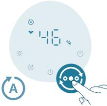
**Ruhemodus** (☾): Der Luftbefeuchter wird leise bei geringer Geschwindigkeit betrieben. Nach 3 Sekunden erlischt die Bildschirmbeleuchtung.
