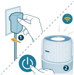
2 Enchufe el humidificador a la toma de corriente y pulse el botón de encendido para encenderlo.
