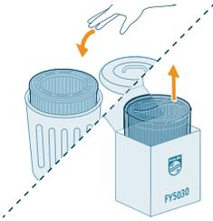
4 Helyezze vissza a párasítószűrőt a víztartályba. Helyezze vissza a felső egységet a víztartályra.
