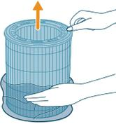
4 Remplacez le filtre dans l'appareil, en veillant à ce que le côté portant le logo soit orienté vers le haut.
