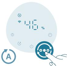
**Način rada za spavanje (C)**: Ovlaživač radi tiho pri maloj brzini. Indikatori zaslona isključit će se nakon 3 sekunde.
