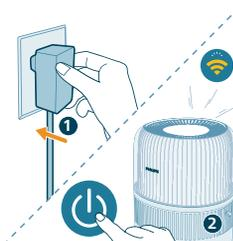
2 Zástrčku zvlhčovača vzduchu zapojte do elektrickej zásuvky a stlačením hlavného vypínača zapnite ohrievač.
