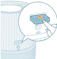
3 Volte a pressionar a caixa do aroma para que encaixe no aparelho.
