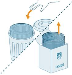
4 Coloque de nuevo el filtro de humidificación en el depósito de agua. Vuelva a colocar la unidad superior sobre el depósito de agua.
