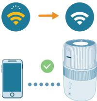
4 Paleiskite programėlę „Philips Air+“ ir spustelėkite **„Pridėti prietaisą“** ar paspauskite „+“ mygtuką ekrane. Norėdami prijungti oro valytuvą prie tinklo, vykdykite ekrane teikiamus nurodymus.
