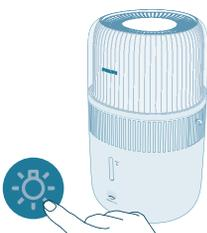
Pode premir o botão de luz para desligar todas as luzes e o painel de controlo. Prima qualquer um dos botões para ativar o painel primeiro e, em seguida, prima o botão de luz novamente para definir o modo de luz pretendido em 3 segundos.
