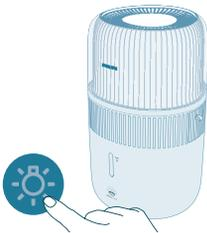
Du kan trykke på lysknappen for å slå av alle lamper og kontrollpanelet. Trykk på en knapp for å aktivere panelet først, og trykk på lysknappen igjen for å stille inn ønsket lysmodus i 3 sekunder.
