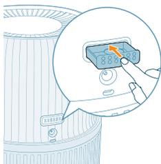
3 Wciśnij pojemnik na aromat z powrotem do urządzenia.
