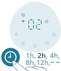
Premere ripetutamente il pulsante del timer per scegliere tra 1, 2, 4, 8 o 12 ore. Al termine della durata del timer, l'umidificatore smette di funzionare automaticamente.
