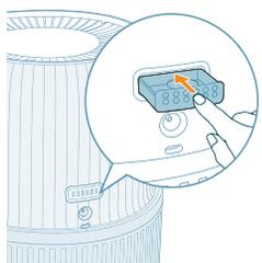
4 Umiestnite aromatisačný box späť do zvlhčovača vzduchu.
