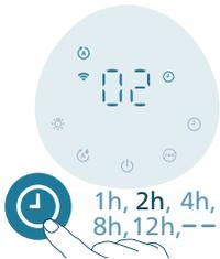
Presione repetidamente el botón del temporizador para seleccionar entre 1, 2, 4, 8 o 12 horas. Cuando finalice el temporizador, el humidificador se apagará automáticamente.
