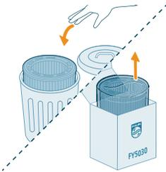
4 Volte a colocar o filtro de humedificação no depósito de água. Volte a colocar a unidade superior no depósito de água.
