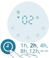
Apasă de mai multe ori pe buton pentru a alege între 1, 2, 4, 8 sau 12 ore. Când temporizatorul se oprește, umidificatorul se oprește automat.
