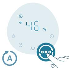
**Modalità silenziosa (☾)**: l'umidificatore funziona silenziosamente e a velocità ridotta. Dopo 3 secondi, lo schermo si spegne.
