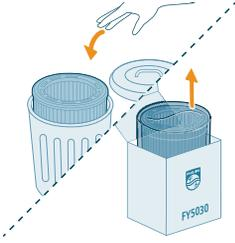
3 Poista pakkausmateriaalit uudesta suodattimesta. Hävitä käytetyt suodattimet.
