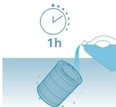
4 Iemērciet mitrinātāja filtru tīrīšanas līdzeklī (piemēram, citronskābes šķīdumā) uz vienu stundu.
