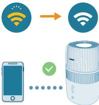
4 Стартирайте приложението Philips "Air+" и щракнете върху **"Add a device"** (Добавяне на устройство) или натиснете бутона "+" на екрана. Следвайте инструкциите на екрана, за да свържете пречиствателя на въздух към вашата мрежа.
