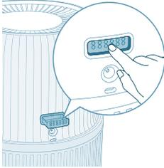
1 Pressione a caixa do aroma para a ejetar automaticamente.
