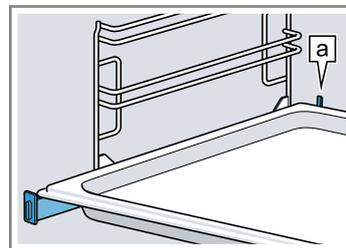
**Hinweis:** Die Auszugsschienen mit etwas Druck zurück in den Garraum schieben.
