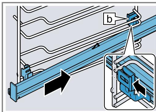
3. **PUSH** gedrückt halten ① und die Auszugsschiene nach innen schwenken ②, bis die Halterung [a] in den unteren Stab eingehängt ist.
