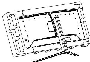
2. Stlačte a podržte uvoľňovacie tlačidlo a podstavec nakloňte a vysuňte ho.
