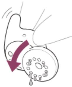
3. Ruotare il foro del microfono verso il basso e picchiettarlo delicatamente per circa 10 volte verso un panno asciutto, ecc. per rimuovere l'acqua raccolta all'interno.
