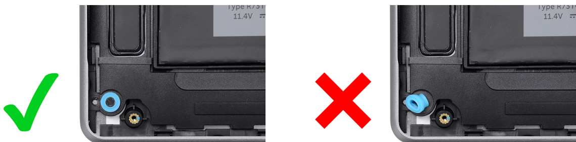
Abbildung 24. Installation der Gummidichtungen
