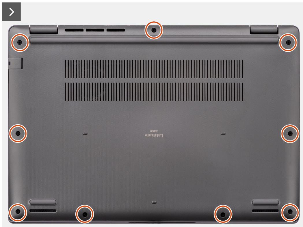
Ilustración 9. Extracción de la cubierta de la base
