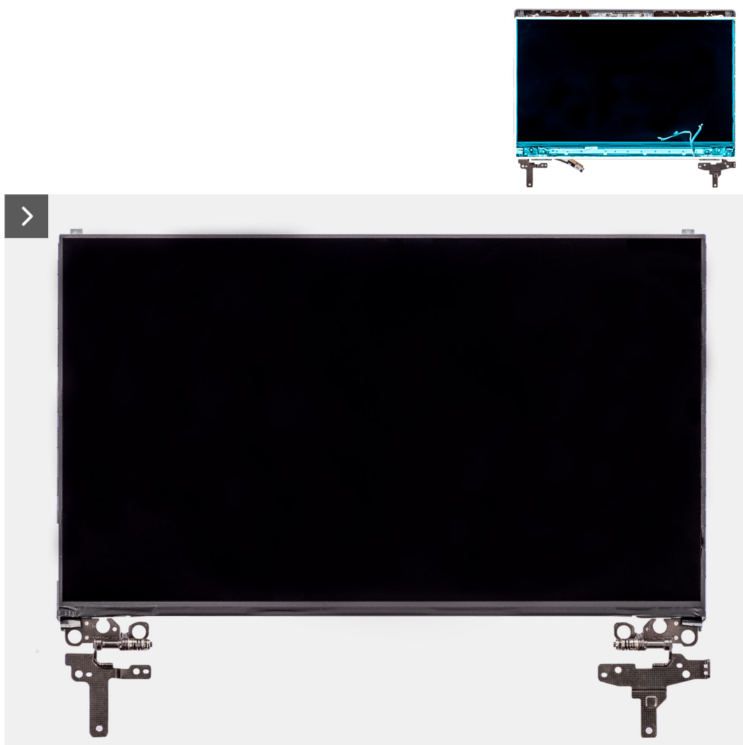
Ilustración 59. Instalación del panel de pantalla
