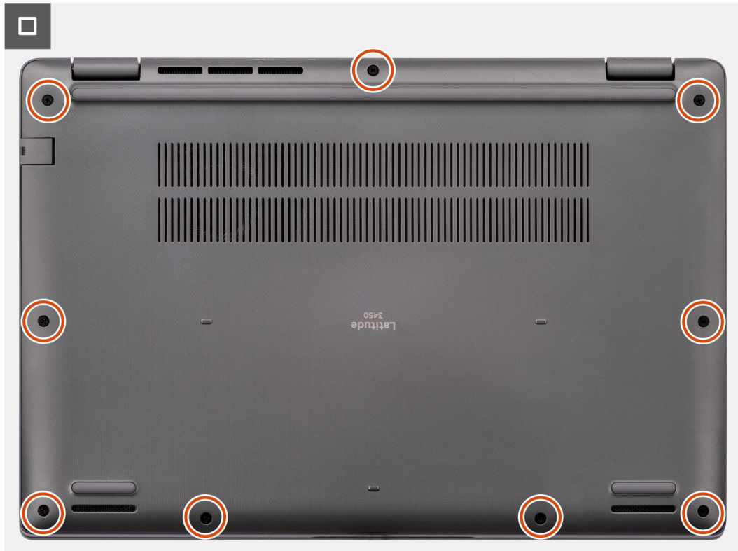
Ilustración 12. Instalación de la cubierta de la base
