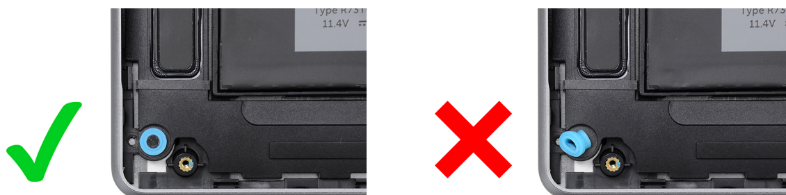
Figura 24. Installazione di gommini
