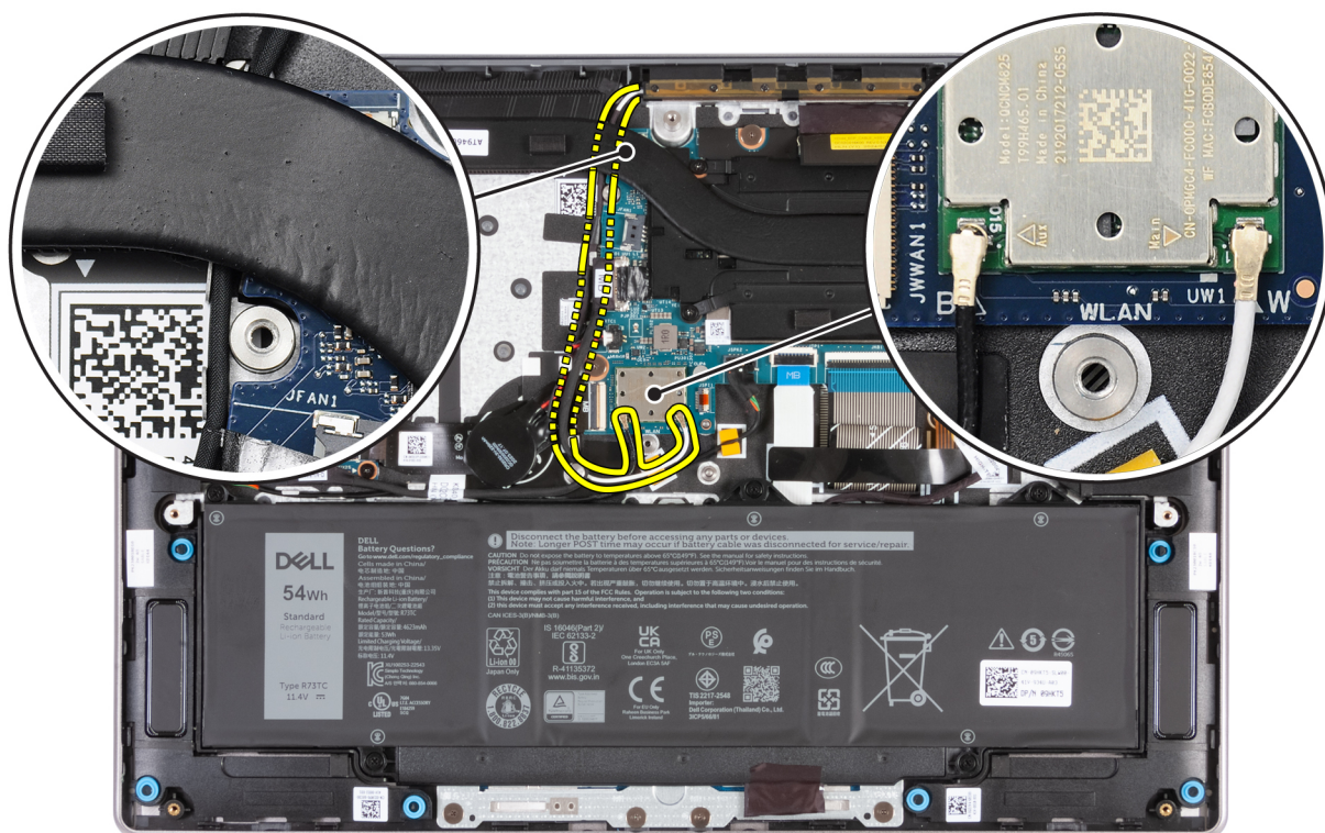
Figura 44. Installazione dei cavi dell'antenna WLAN
