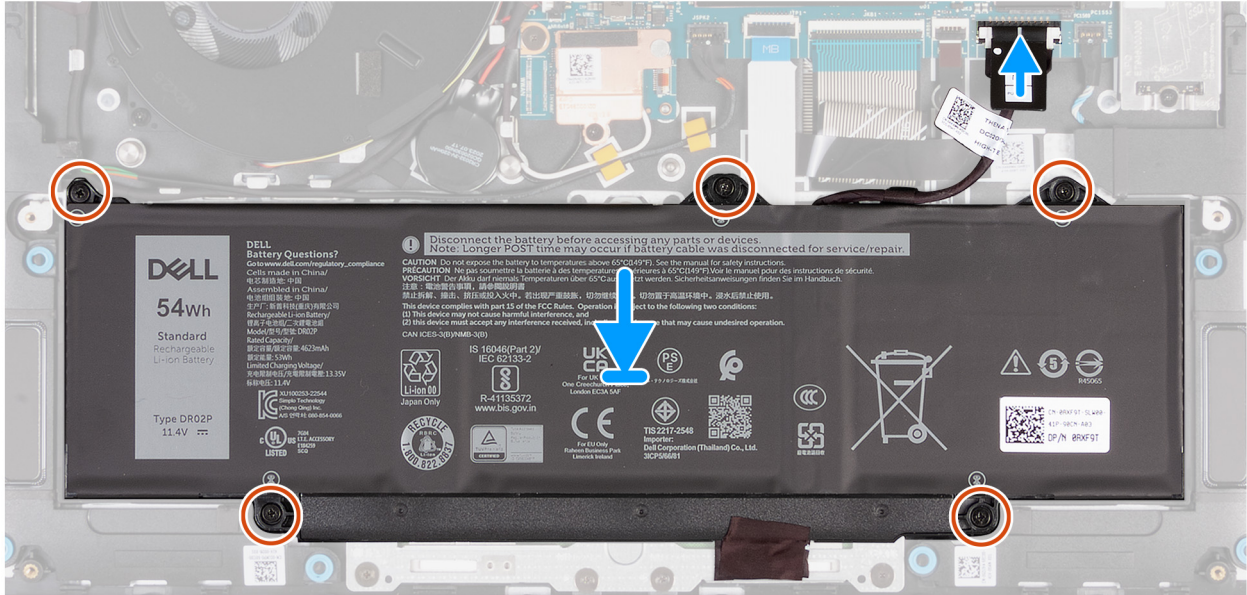
Figura 28. Installazione della batteria
