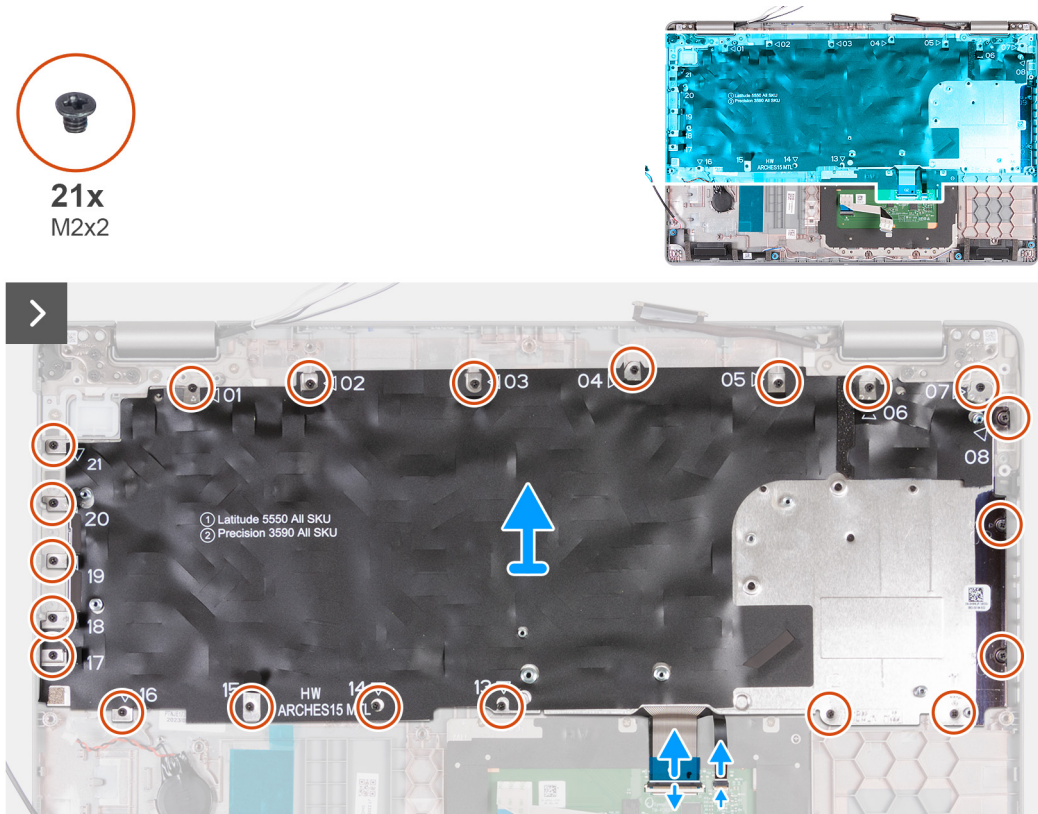
Afbeelding 65. Het toetsenbord verwijderen
