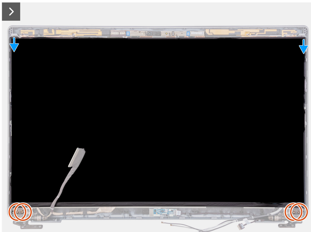
Afbeelding 76. Het beeldschermpaneel verwijderen
