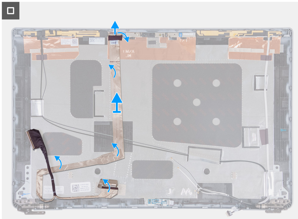
Afbeelding 90. De beeldschermkabel verwijderen
