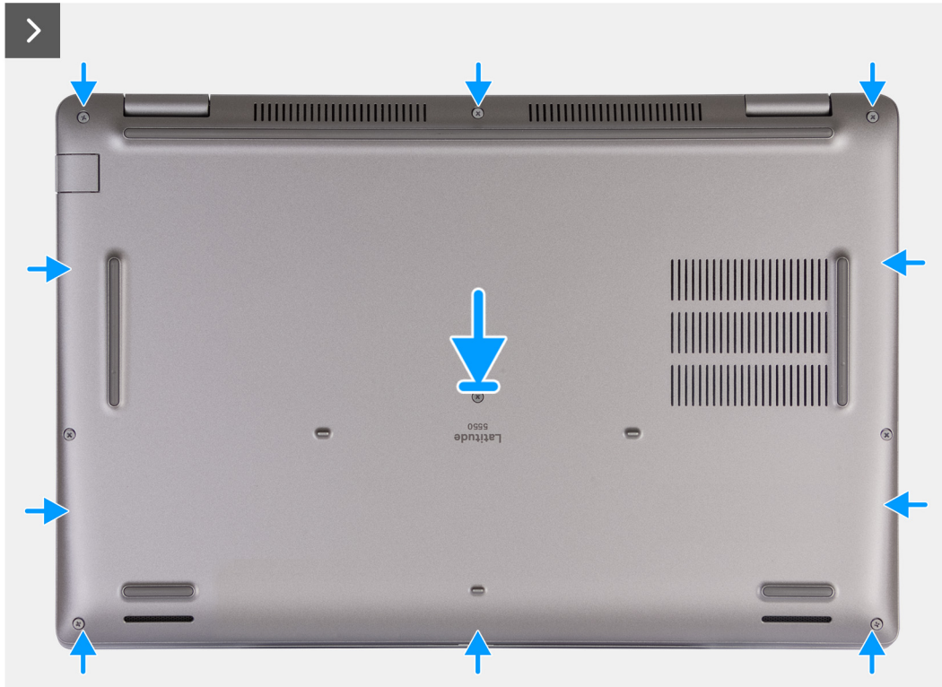
Afbeelding 17. De onderplaat plaatsen
