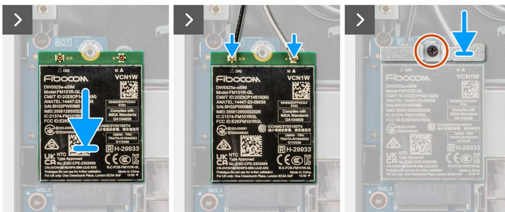
Figura17. Instalar a placa WWAN
