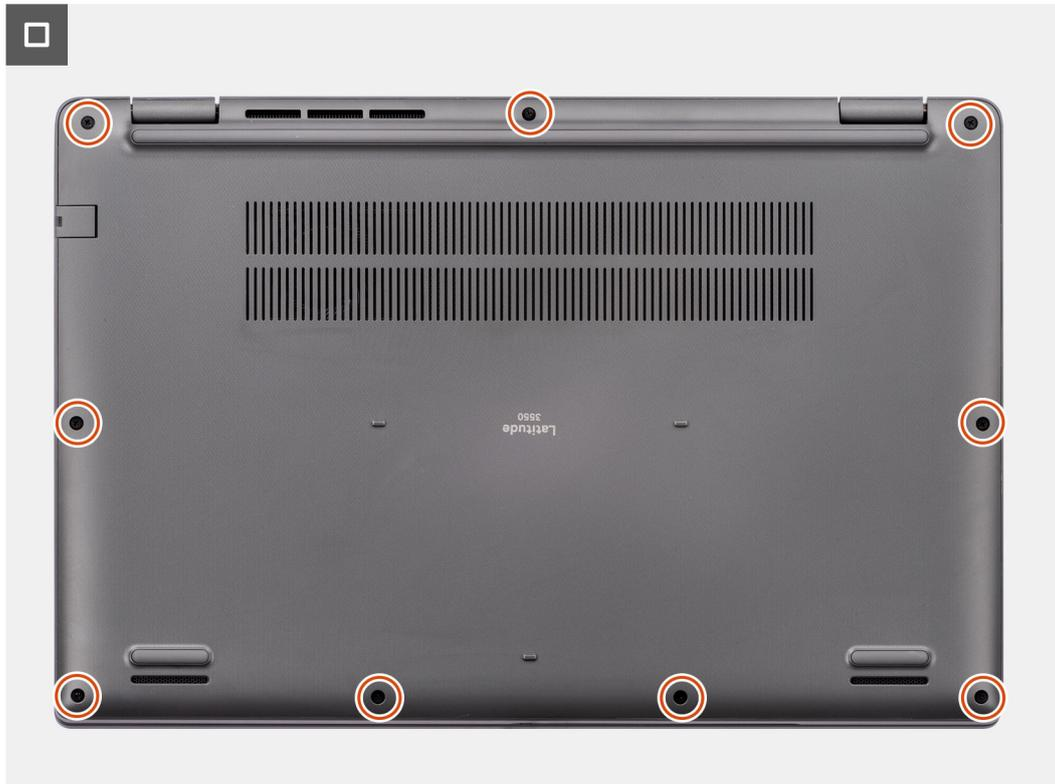
**Figura11. Instalar a tampa da base**
