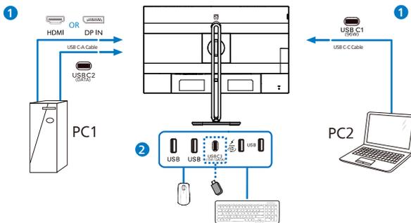
3. Accedere al menu OSD. Andare al livello KVM e selezionare "Auto", "USB C1" o "USB C2" per cambiare il controllo delle periferiche da un dispositivo a un altro. Basta ripetere questo passaggio per commutare il sistema di controllo usando un set di periferiche.
