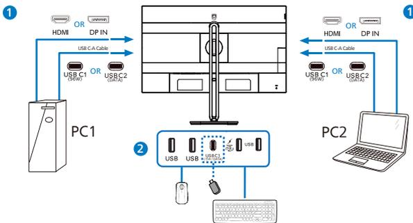
3. Accedere al menu OSD. Andare al livello KVM e selezionare "USB C1" per cambiare il controllo delle periferiche da un dispositivo a un altro. Basta ripetere questo passaggio per commutare il sistema di controllo usando un set di periferiche.
