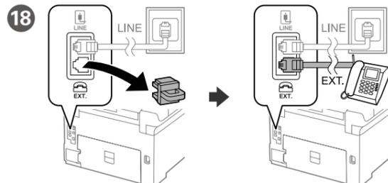
Si desea compartir la misma línea telefónica que el teléfono, quite la tapa y, a continuación, conecte el teléfono al puerto EXT.
