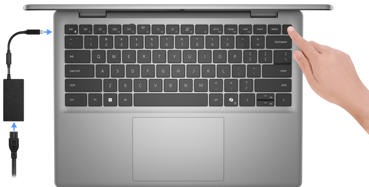
Obrázek 7. Připojte napájecí adaptér a stiskněte vypínač
